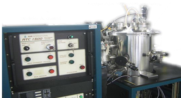
Figura 13. Magnetron sputtering AJA ATC 1500, laboratorio de recubrimientos duros y aplicaciones industriales-RDAI, Universidad del Valle. (RDAI)
