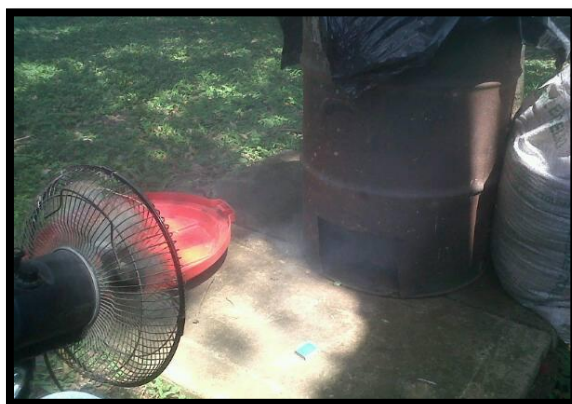
Figura 10. Arreglo utilizado para hacer la quema del cisco de café y obtener la ceniza.
