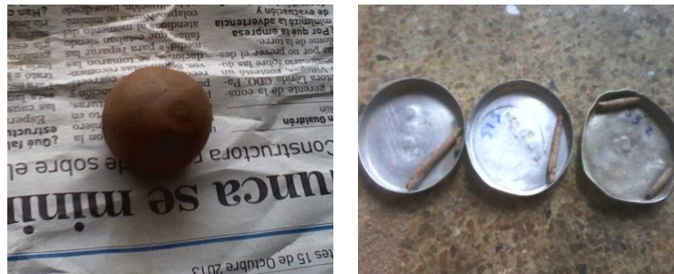
Figura 7. Amasado y formación de los cilindros
