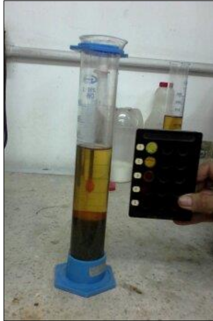
Figura 6. Ensayo de colorimetría del agregado fino (arena)
