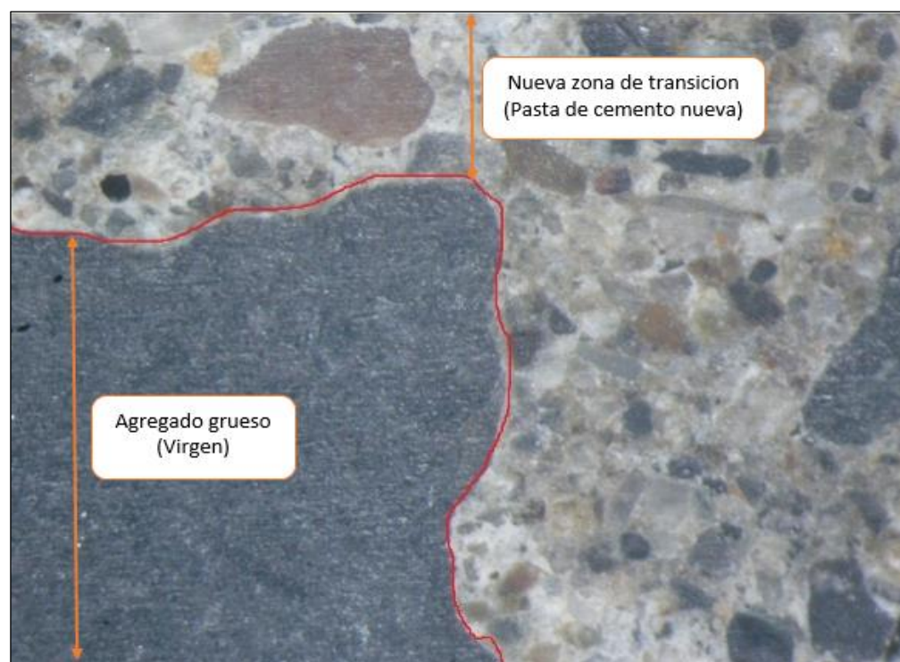
Figura 21. Imagen estereoscópica del espécimen tipo patrón a 15X
