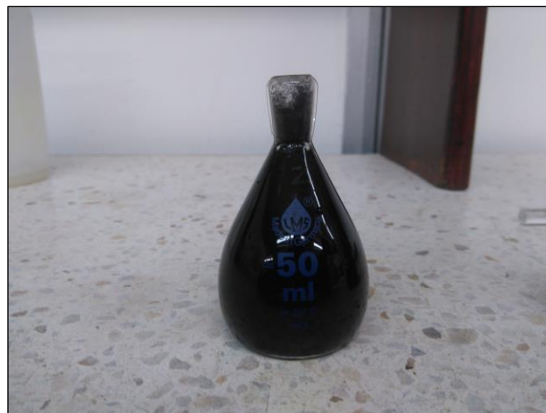
Figura 10. Determinación de la densidad de la ceniza de cascarilla de arroz
