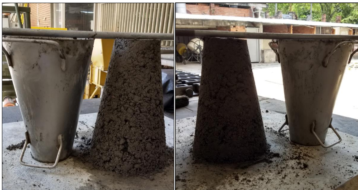
Figura 15. Asentamiento, grava natural, sustitución de 100\text{kg/m}^3 de RHA y JPF en 3% y 5% respectivamente.
