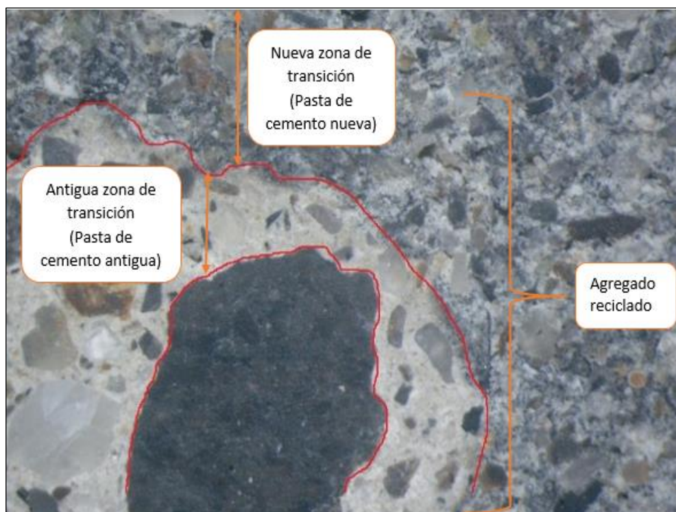
Figura 22. Imagen estereoscópica de la mezcla final a 12X
