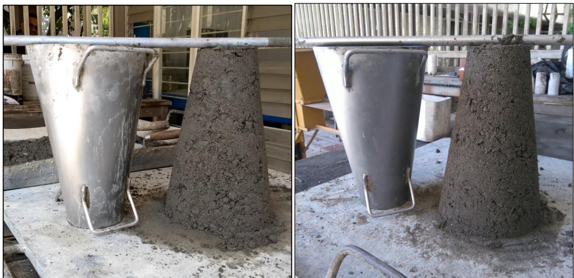
Figura 17. Asentamientos, mezcla final 3% y 5% de jugo de fique respectivamente
