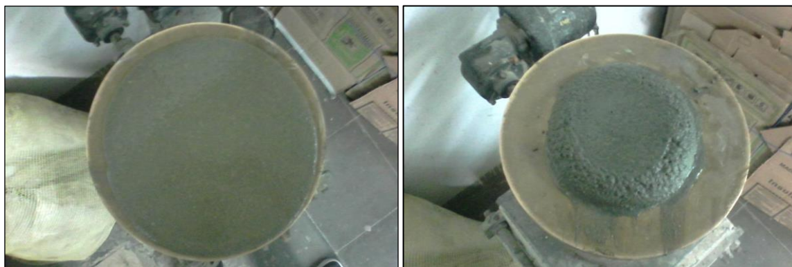
Figura 12. Mesa de flujo para el 0% y 20% de sustitución de cemento por RHA respectivamente
