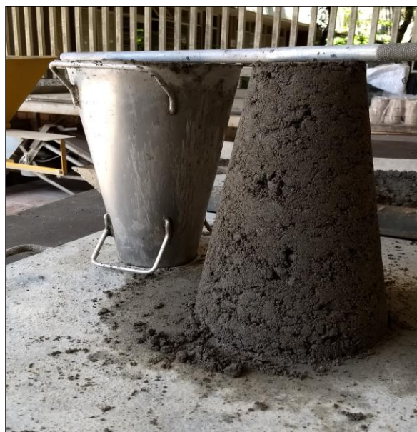
Figura 14. Asentamiento, sustitución de ceniza de cascarilla de arroz por arena
