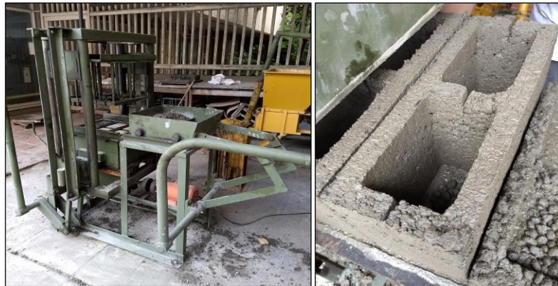
Figura 18. Proceso de elaboración de bloques estructurales de concreto mezcla final
