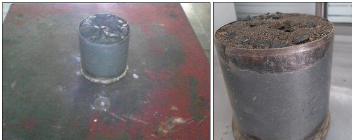
Figura 3. Ensayo experimental de adición de agua para la determinación de espacios vacíos.
