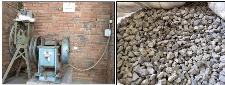
Figura 4. Molino de mandíbulas y agregado grueso reciclado (tamaño máximo \frac{1}{2} " )
