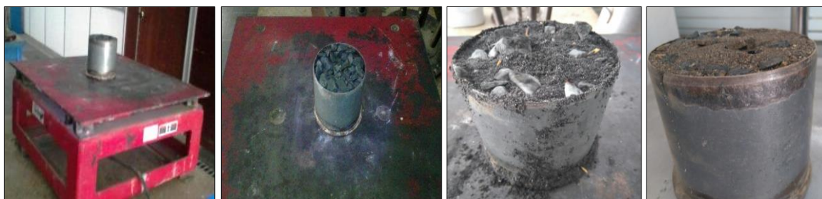
Figura 2. Paso a paso ensayo experimental de vibración para la determinación de vacíos
