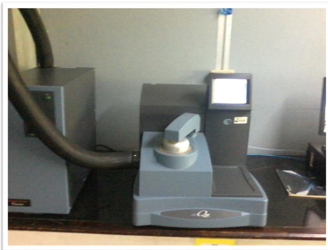
Figura 1. Calorímetro diferencial de barrido Q200 utilizado para el estudio de las compositas (1-X) \text{CsHSeO}_4 - (X) \text{Fe}_2\text{O}_3 con X entre 0,1-0,5.
