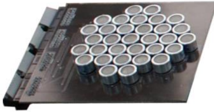
Figura 7. Multitransductor plano de 32 elementos piezo-cerámicos de 40 kHz.
