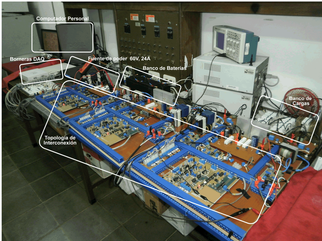
Figura 71. Componentes presentes en la implementación de las topologías de interconexión en el laboratorio
