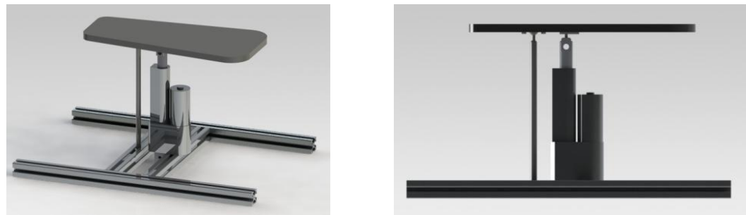
Figura 9: máquina de rehabilitación de tobillo. (A. Blanco Ortega, H. R. Azcaray Rivera, R. F. Vázquez Bautista, L.J. Morales Mendoza)
