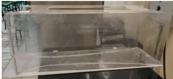
Figura 5.15. Canal de aforo Venturi construido
