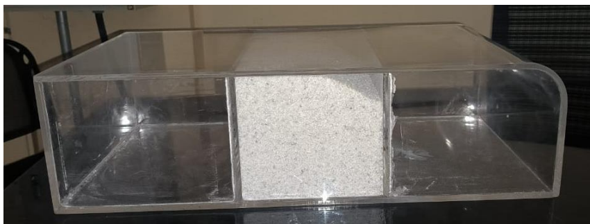
Figura 5.11. Vertedero de pared gruesa construido
