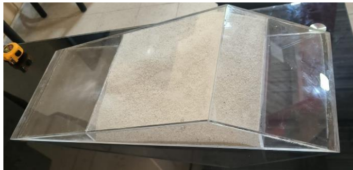
Figura 5.9. Vertedero tipo Crump construido
