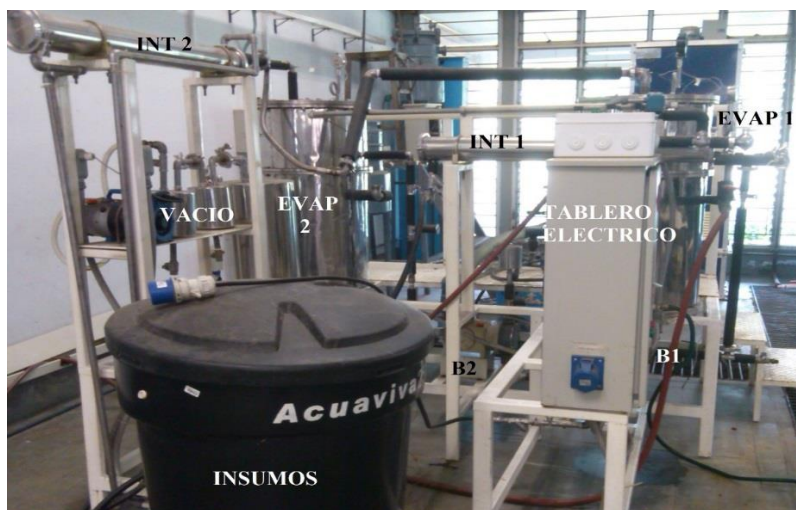
Figura 4. Subsistemas identificados en el evaporador de doble efecto
