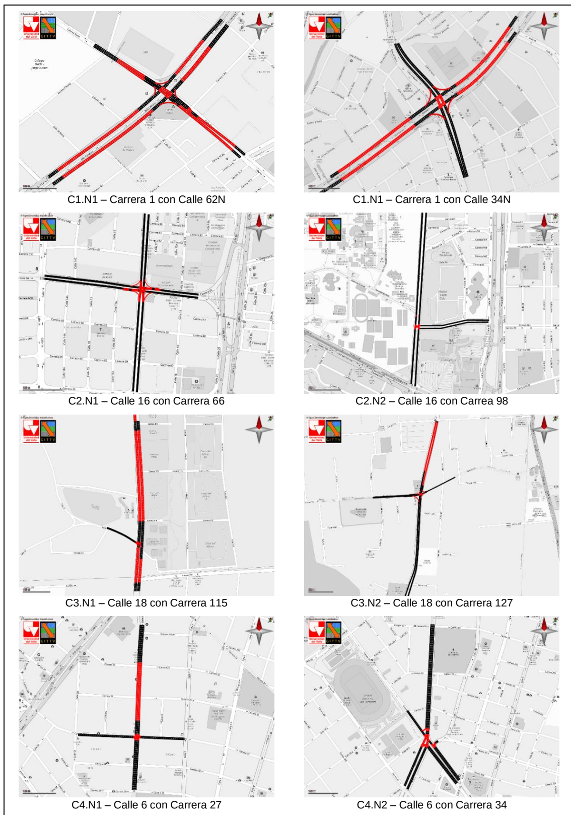
Figura 13. Intersecciones modeladas visualizando links (en negro) y conectores (en rojo).
