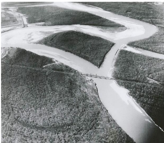
Ilustración III. Fotografía No.18470-6 Muestra un corte similar. El río ha recorrido el nuevo canal y el punto de corte está llevando la mayor parte de la corriente del río
