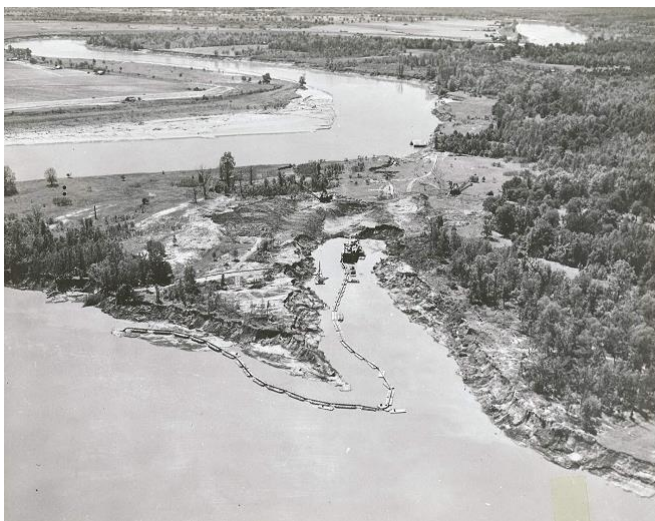
Ilustración II. Fotografía No.20560-37 Muestra un corte parcialmente hecho en el Red River en Arkansas, U.S.A.
