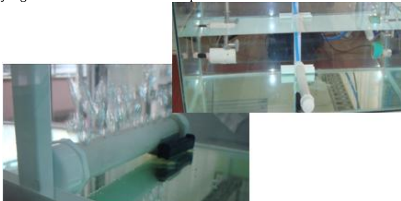
Figura 68. Burbujas generadas con un tubo de PVC perforado
