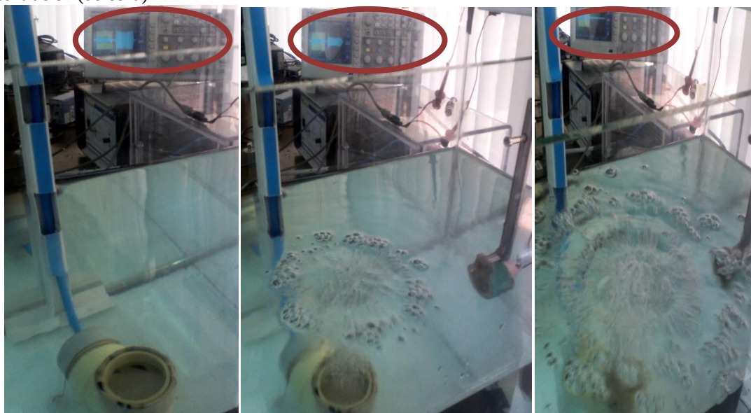
Figura 70. Señal recibida sin burbujas (izquierda), con burbujas baja concentración (medio) y alta concentración (derecha)
