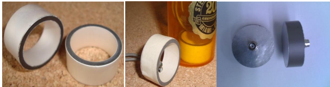
Figura 40. a) Cerámica piezoeléctrica con electrodos en bruto, b) Cerámica cableada antes de encapsular, c) Transductor piezoeléctrico con la capa de adaptación
