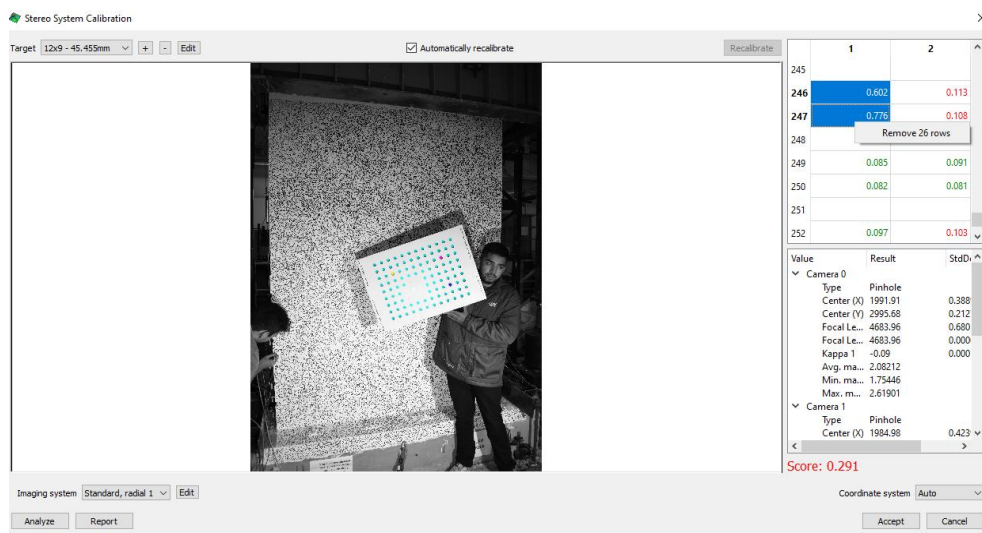
Figura 15. Resultados de la calibración y su respectivo error medio previo a eliminar las imágenes con errores muy altos.
