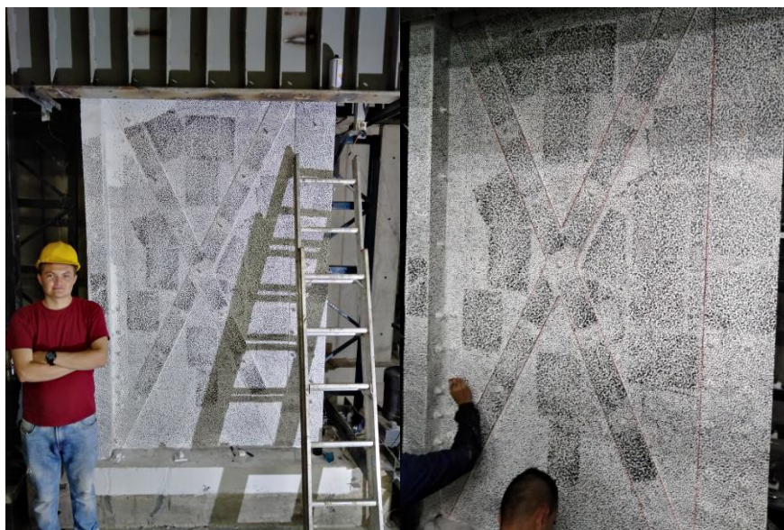
Figura 53. Aplicación del patrón de puntos con la plantilla tipo stencil. Se observa cómo queda un patrón poco homogéneo, con mal aspecto, mala distribución y con diferencia de tonalidad en las tintas de la pintura con respecto a los marcadores.
