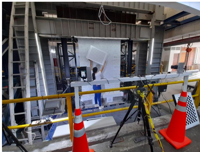
Figura 21. Sistema de iluminación definitivo, compuesto por los reflectores y luces led distribuidas en el marco de pruebas, configuración #2.
