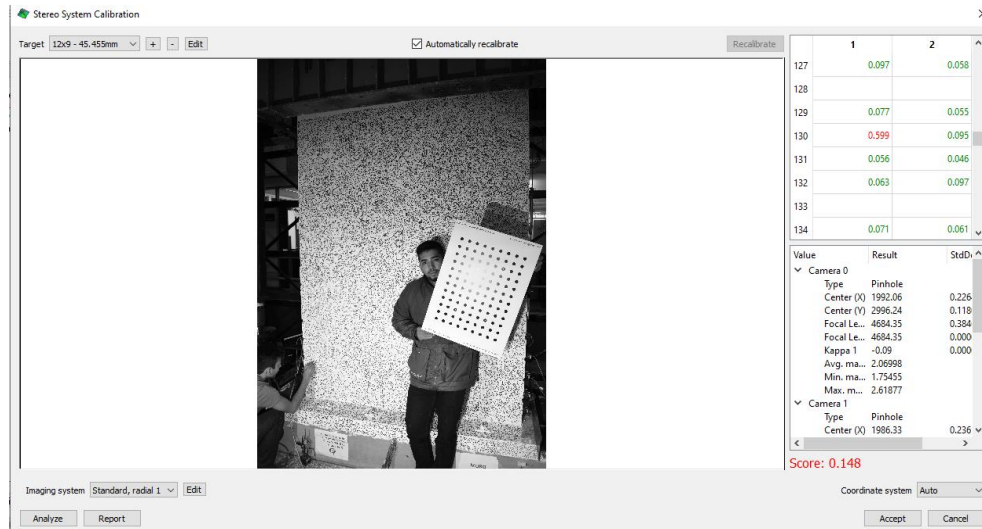
Figura 16. Resultados de la calibración y su respectivo error medio después de eliminar las imágenes con errores muy altos.
