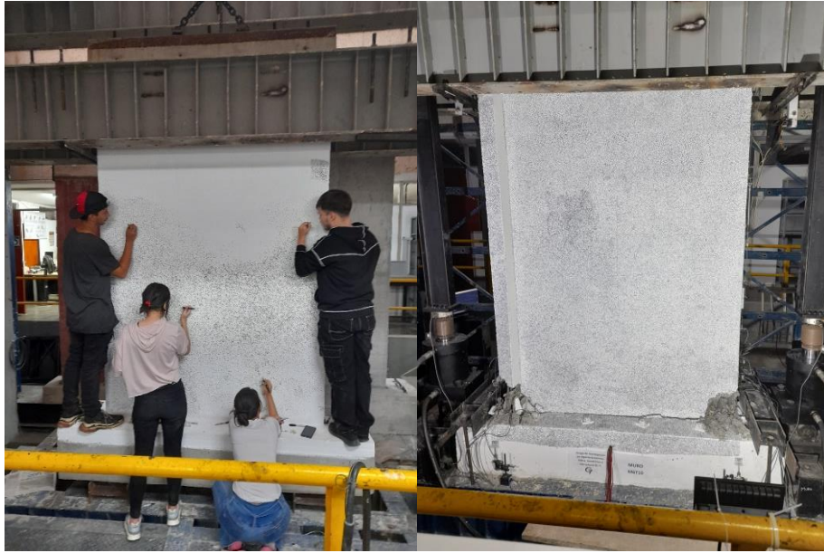
Figura 52. Aplicación del patrón aleatorio de puntos de forma manual con marcadores sharpie en un muro de concreto reforzado. Se observa el resultado del patrón aleatorio, de muy buena calidad, densidad y con buena distribución.
