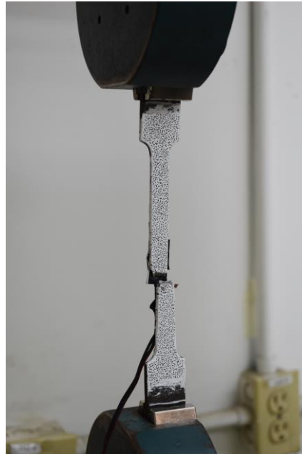
Figura 45. Ensayo de tracción en platinas hasta la falla.
