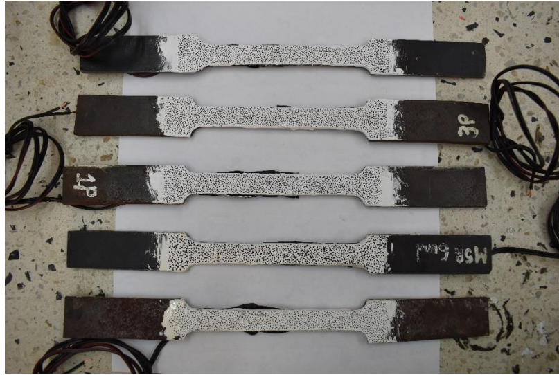
Figura 54. Probetas de acero con el patrón aleatorio de puntos aplicado en su superficie.
