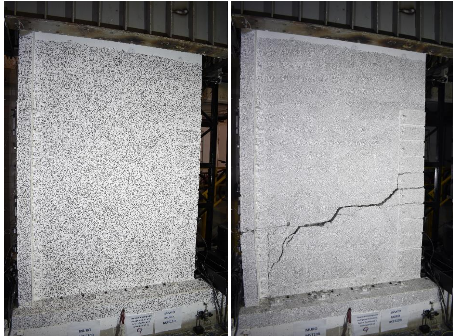
Figura 59. Campo de visión de las cámaras para diferentes estados del ensayo de carga cíclica en muros.
