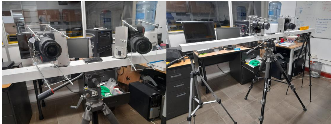
Figura 23. Configuración del sistema DIC contra explosiones de probetas.
