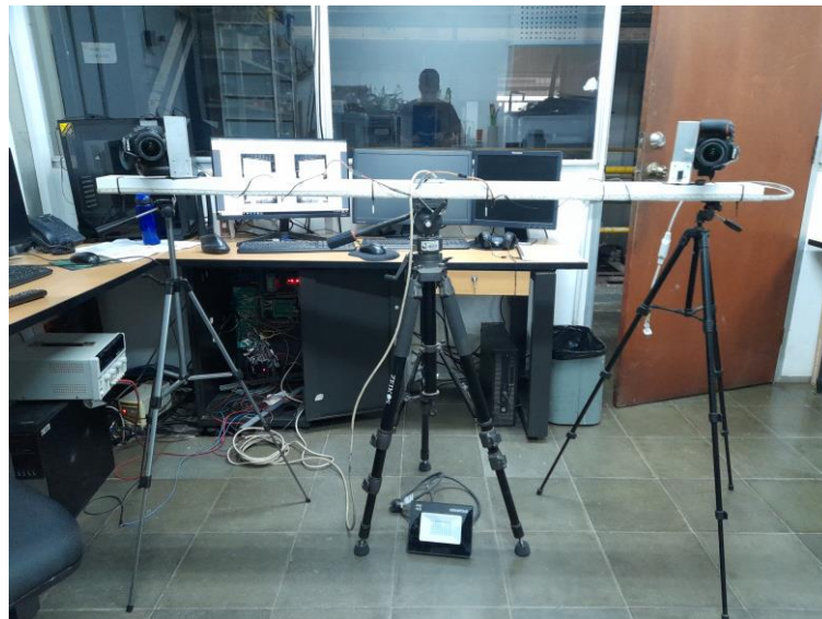
Figura 18. Sistema de soporte definitivo para la configuración estéreo de cámaras.
