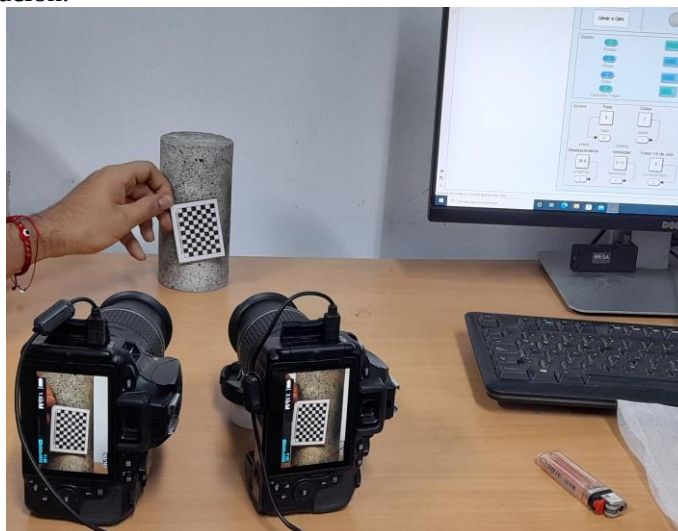
Figura 9. Prueba de calibración con el patrón de ajedrez de 5mm de lado.
