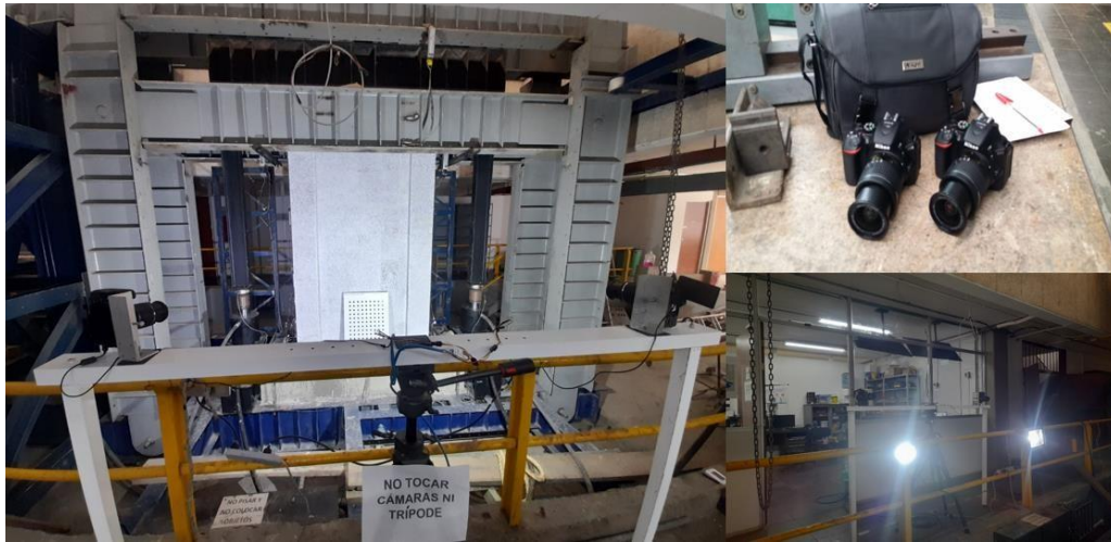
Figura 33. Sistema estéreo de correlación digital de imágenes propuesto.
