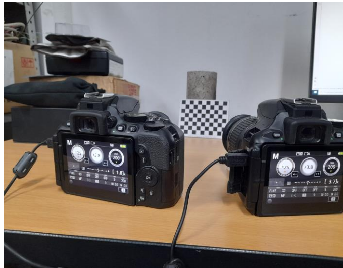
Figura 5. Prueba de calibración con el patrón de ajedrez de 10mm de lado.
