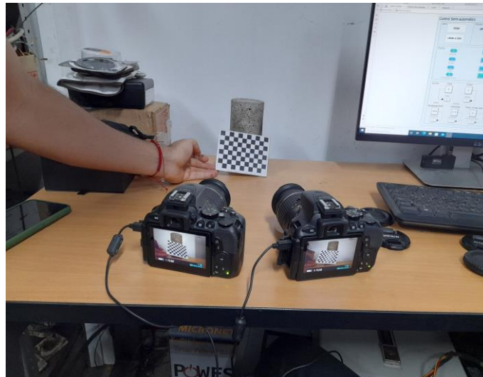
Figura 7. Prueba de calibración con el patrón de ajedrez de 7mm de lado.
