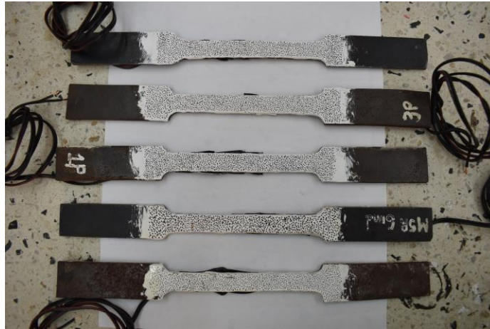
Figura 43. Platinas de acero con el patrón aleatorio de puntos en su superficie.
