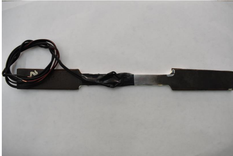
Figura 44. Strain gauge instalada y cableada en la probeta de acero.
