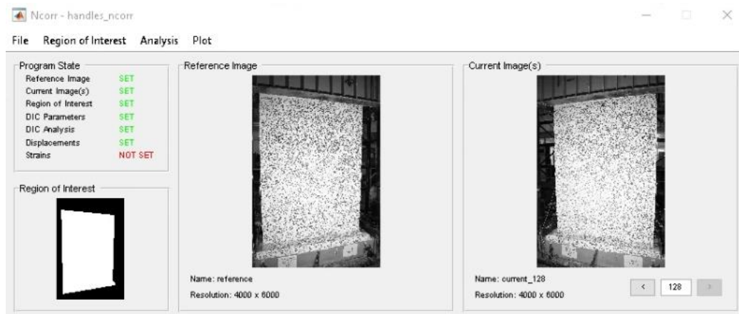
Figura 45. Interfaz principal de NCORR con el estado actual de los pasos del procesamiento.
