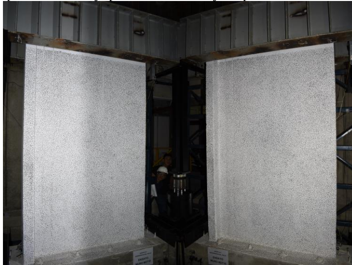
Figura 19. Desfase entre capturas para el ensayo del muro M2T, cámara 0 y cámara 1.
