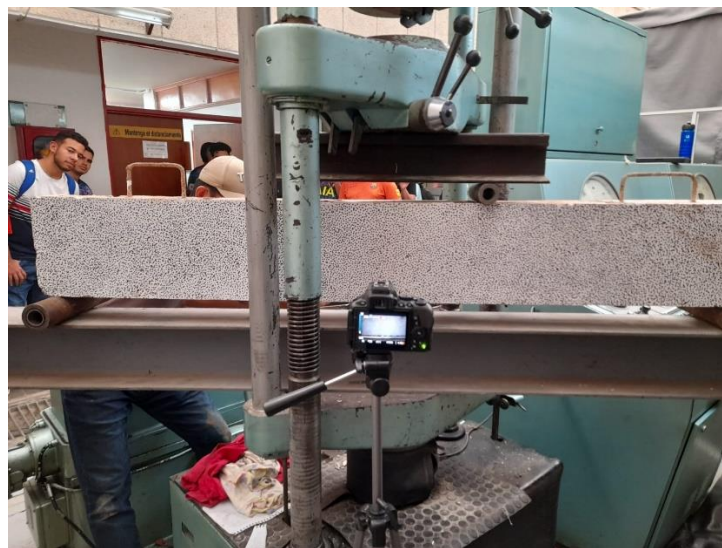
Figura 29. Sistema DIC de bajo costo para correlación digital de imágenes en 2D; configuración para ensayos de flexión en vigas de concreto reforzado.
