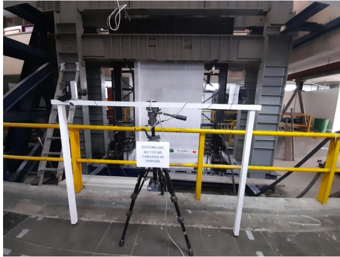
Figura 17. Sistema de soporte inicial para la configuración estéreo de cámaras.
