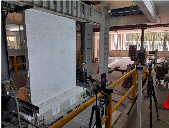
Figura 32. Implementación del sistema estéreo DIC en una prueba cíclica en muros de concreto reforzado.
