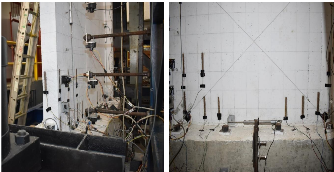
Figura 1. Instrumentación de un muro de concreto reforzado con sensores (LVDT's, deformímetros, strain gauges, entre otros).
