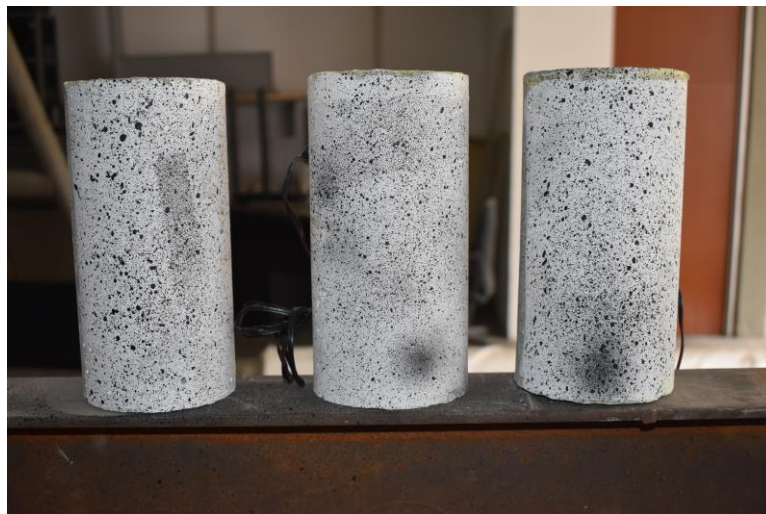
Figura 56. Cilindros de concreto con el patrón aleatorio de puntos aplicado en su superficie.
