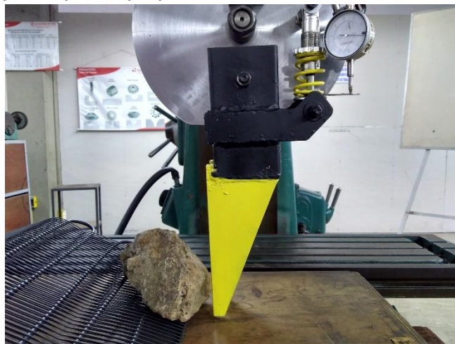
Figura 4.3 Montaje del prototipo y el rastrillo sobre la Fresadora Universal
