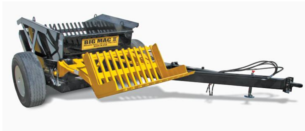
Figura 1.4. Accesorio en forma de rastrillo con tolva adaptable.
