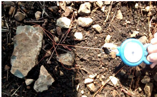
a. Medición de la fuerza necesaria para desprender la roca
