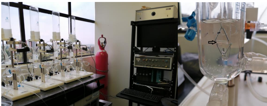
Figura 23. Estación del equipo de baño de órgano aislado. Marca Biopac con 4 cámaras de capacidad 20 ml, flujo de carbógeno en cada cámara, sistema de calentamiento de cámaras a 37°C, PC con software Acknowledge v 3.07, Transductores de tensión y termostato (37°C).
