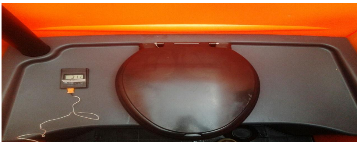
Figura 6. Temperatura dentro de una USP ubicada bajo la sombra de un árbol
