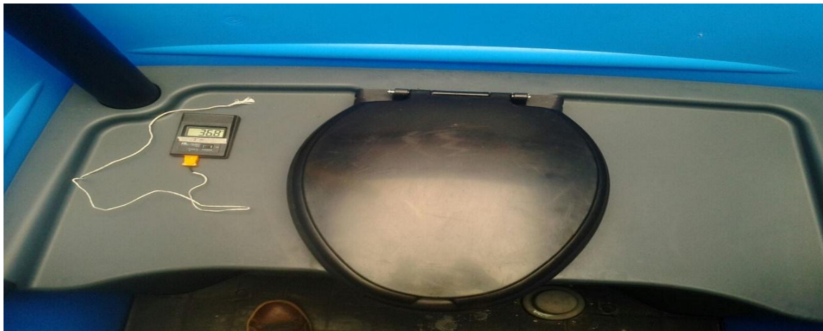
Figura 5. Temperatura dentro de una USP ubicada directamente bajo el sol
