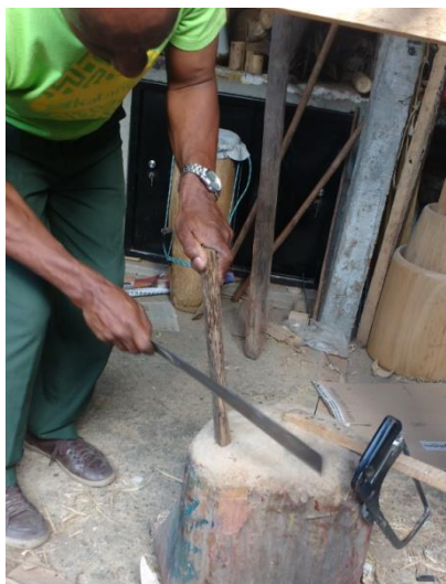
Imagen 14. Corte de la madera para la construcción de las tablas. En la foto el maestro Addo Obed Possú Dinas “Katanga” en su taller. Fuente: elaboración propia.
