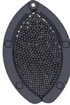
Figura 15. Imagen que muestra la cantidad de cañas que puede contener aproximadamente las tenazas de una alzada.
