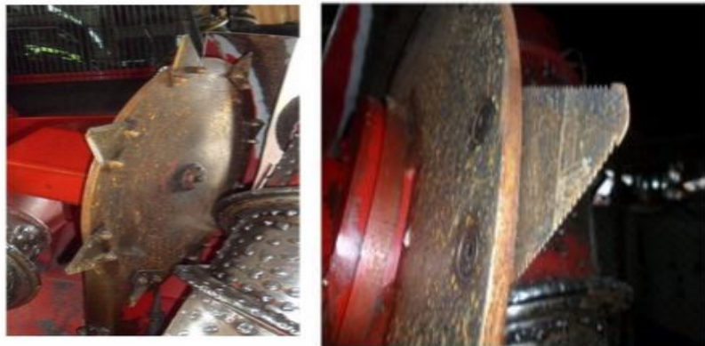
Figura 7. Cuchillas laterales de la cosechadora. Fuente: http://es.slideshare.net/JuanCeni/presentacion-opcion-cuchillas-cortadoras-44687237
