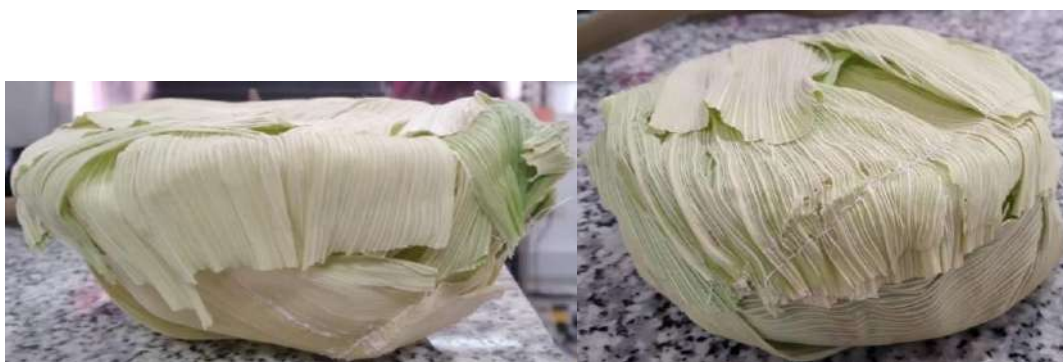
Figura 34. Prueba de encaje entre la tapa y la base después del secado. Elaboración propia.
