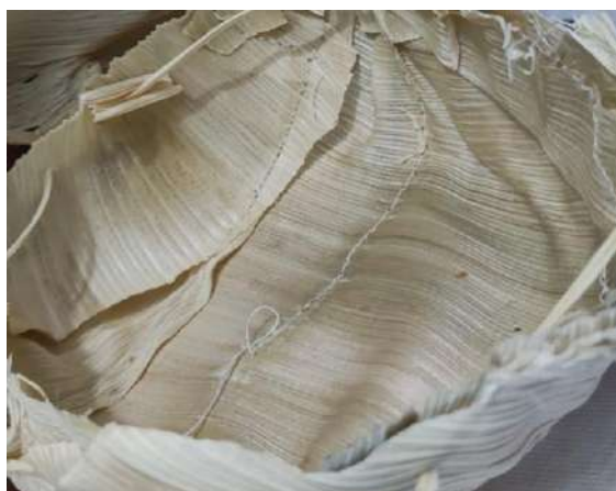
Figura 41. Muestra interior de grasa y humedad en base del empaque 2. Elaboración propia.
