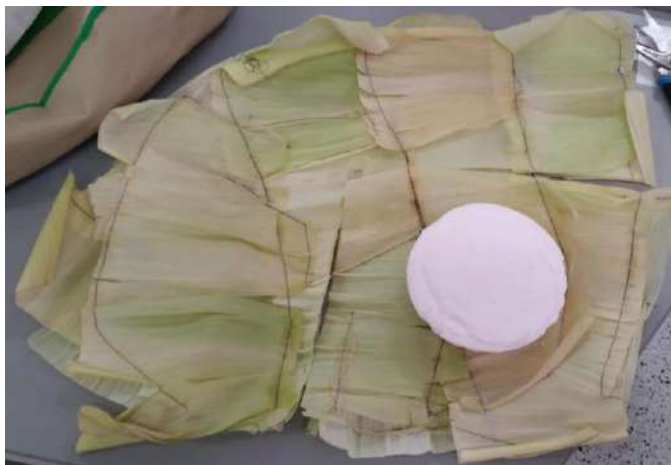
Figura 23. Tela de chalas unidas con hilo en máquina de coser. Elaboración propia.
