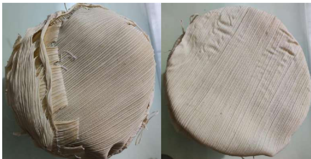
Figura 42. Muestra exterior de empaque sin grasa o humedad. Elaboración propia.
