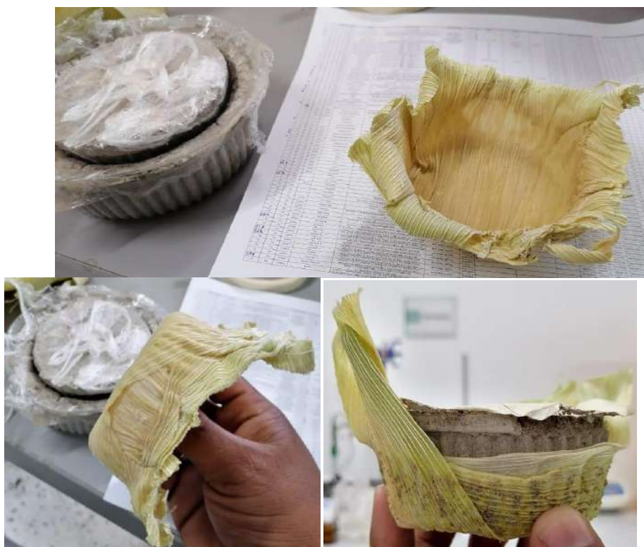
Figura 18. Tela de hojas en molde de concreto con aplicación de calor. Elaboración propia.
