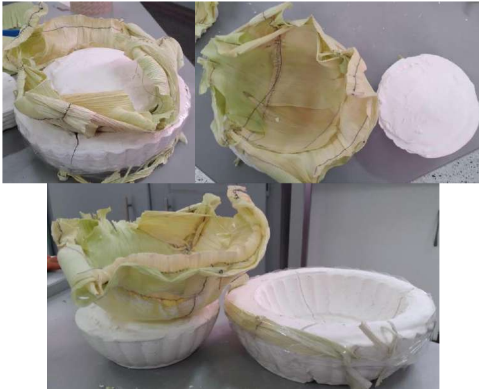
Figura 26. Prueba de la tela de hojas con el molde y aplicación de calor. Elaboración propia.
