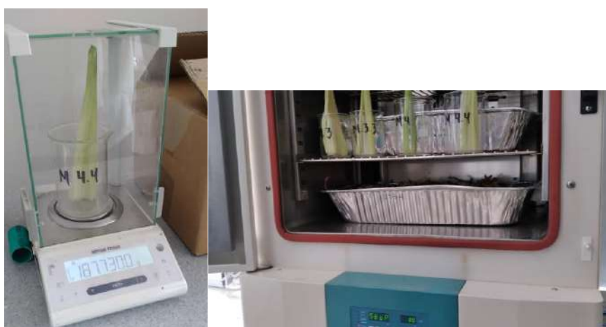
Figura 10. Chalas pesadas y en horno con vaso de precipitado. Elaboración propia.
