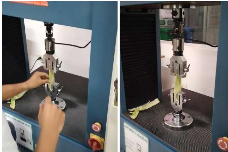
Figura 14. Posicionamiento de muestra de chala en máquina universal. Elaboración propia.
