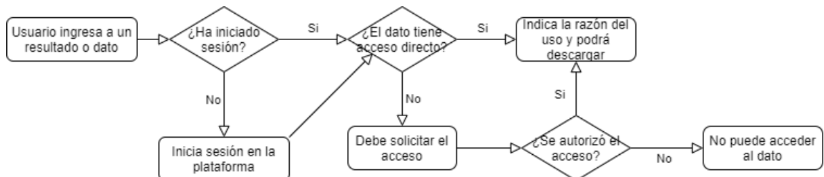
Figura 8. Diagrama lógico del acceso a un dato
