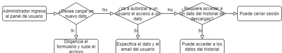
Figura 11. Diagrama lógico del uso del panel de administración
