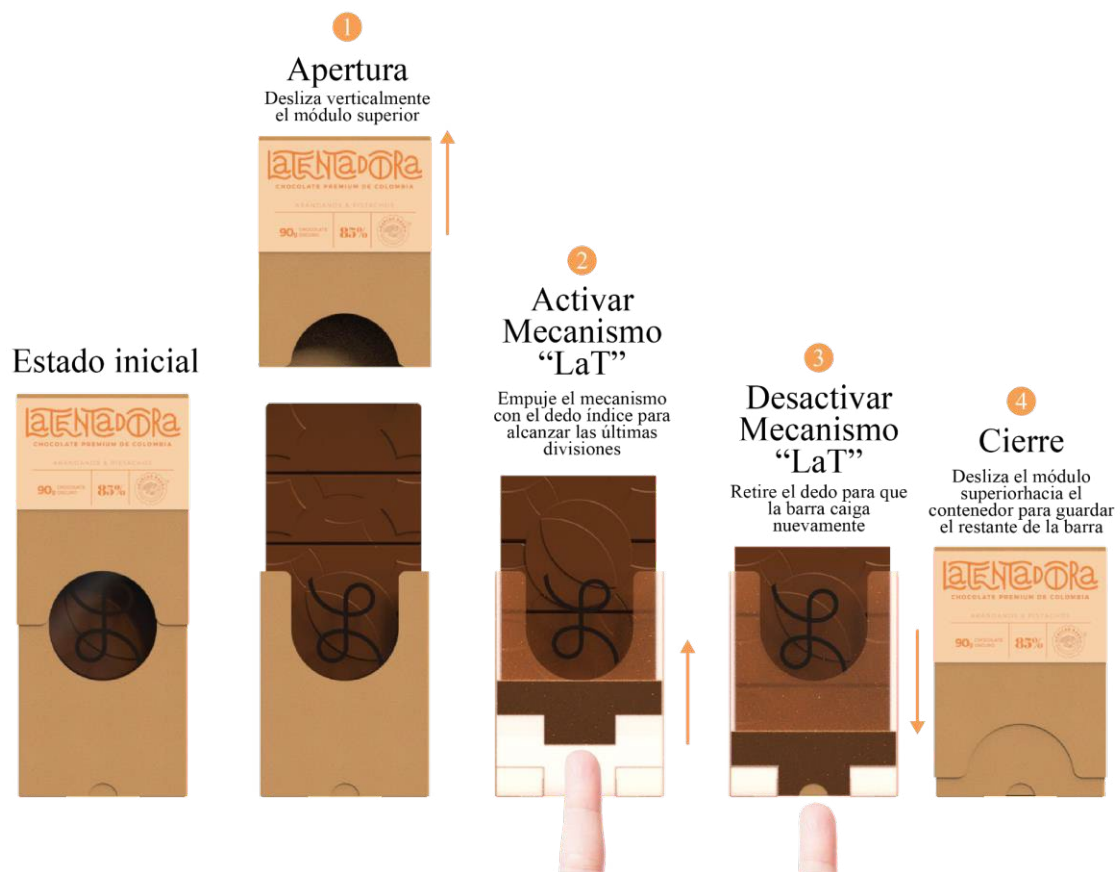
Figura 39. Paso a paso e interacción del mecanismo T del empaque secundario. Fuente: Elaboración propia
