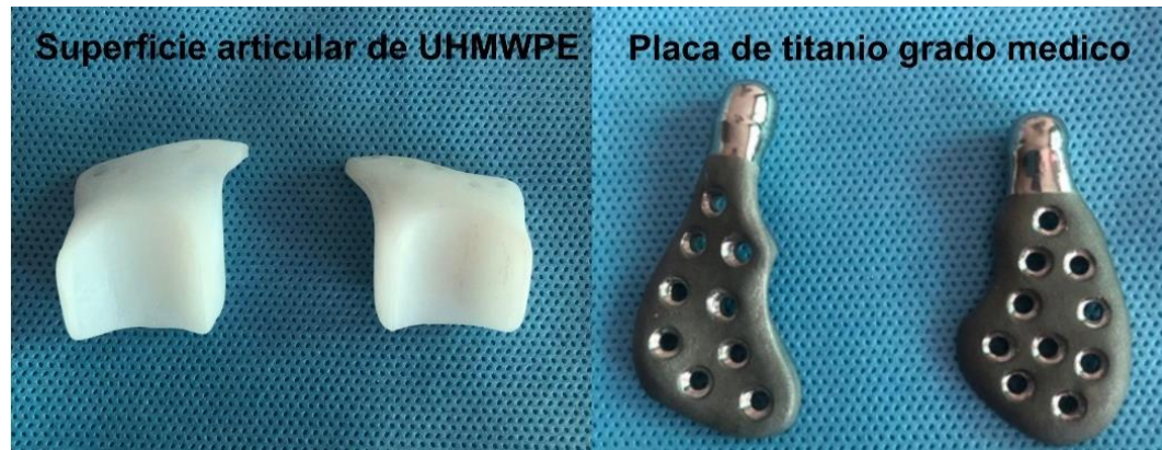
Figura 29 Componentes de una prótesis articular ATM a la medida del paciente fuente autor Los principales objetivos clínicos de un reemplazo total de articulación temporomandibular son: (Wolford., 2003), (Mercuri., 2004) (Jhonson, 2017) (Celebi, 2011).
