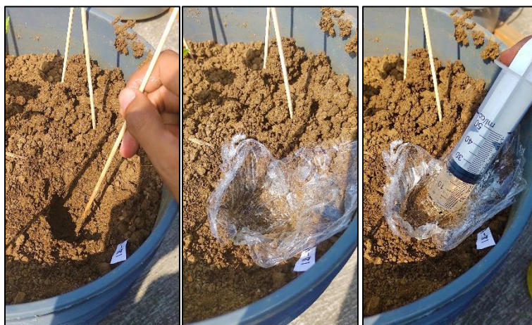
Figura 6. (De izquierda a derecha) excavación del agujero, impermeabilización del agujero y extracción del agua agregada.
