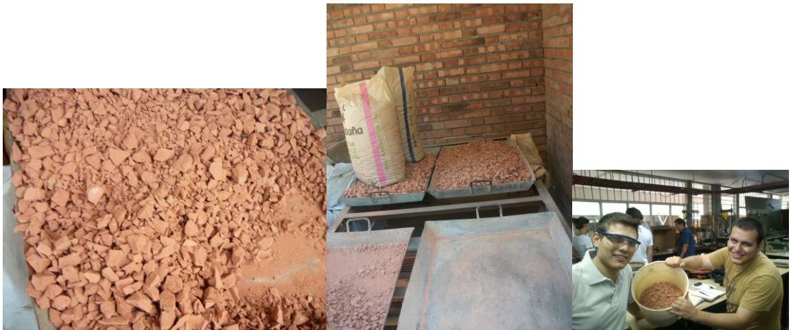
Foto No. 1 : Ladrillo estructural reciclado
