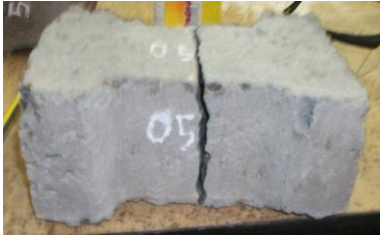
Especimen No. 05 0% de sustitución
