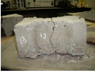
Espécimen No. 13 10% de sustitución
