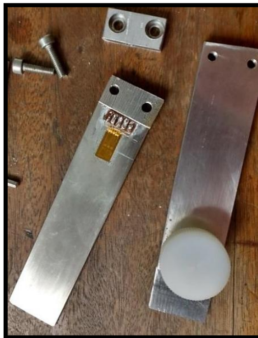
Figura 19. Celda de carga en conjunto con la galga extensiométrica
