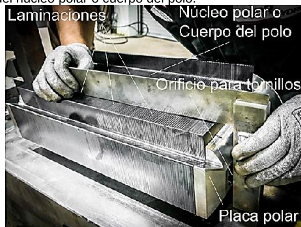
Figura 6. Elementos del núcleo polar o cuerpo del polo.
