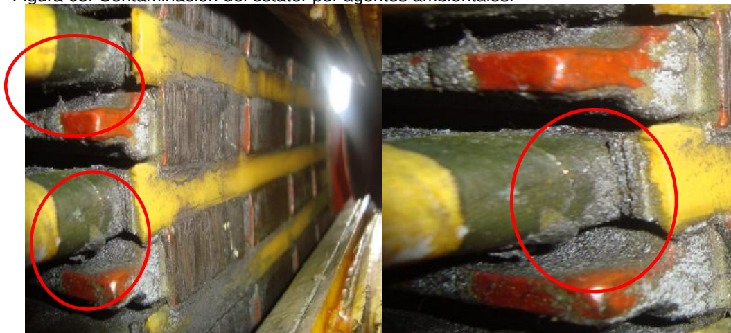
Figura 65. Contaminación del estátor por agentes ambientales.
