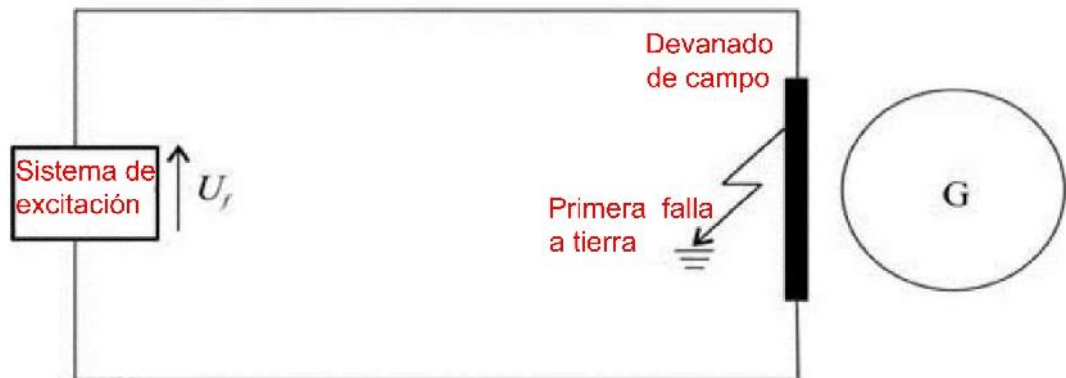
Figura 53. Primera falla a tierra en el devanado de campo.
