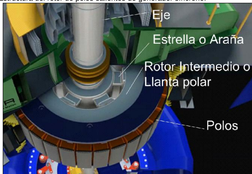
Figura 4. Estructura del rotor de polos salientes de generador síncrono.
