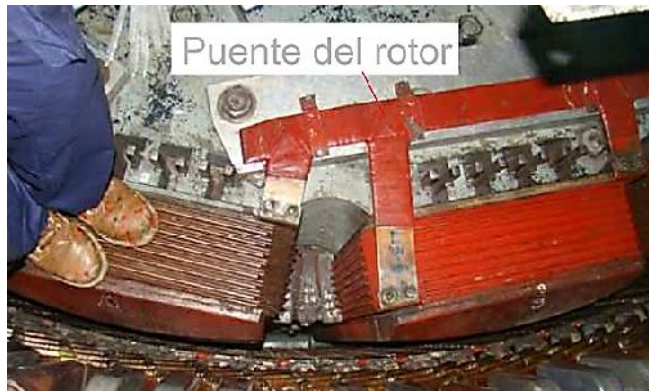
Figura 11. Puente del rotor.
