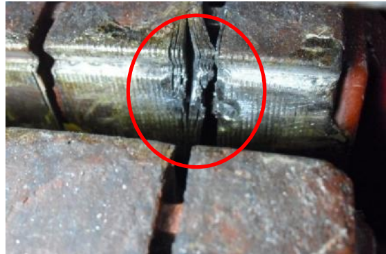
Figura 63. Daño causado en el núcleo del estátor.
