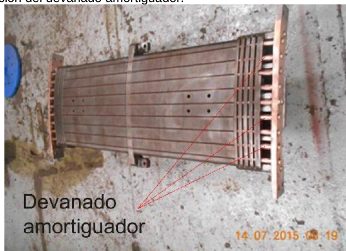
Figura 14. Ubicación del devanado amortiguador.
