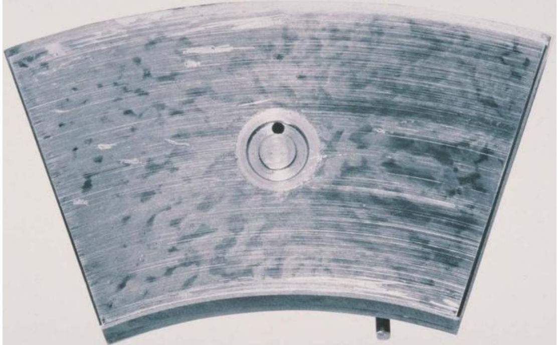
Figura 37. Abrasión de la superficie del zapato de empuje.
