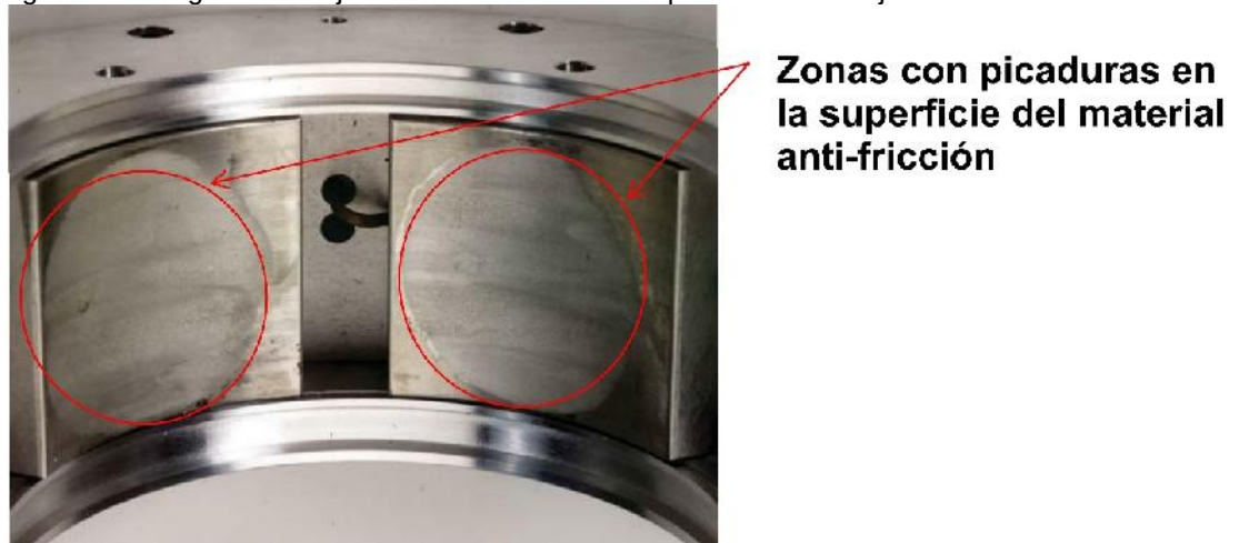
Figura 36. Desgaste en cojinete debido a corrientes parasitas en el eje.
