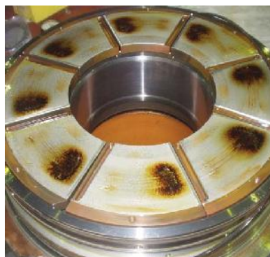
Figura 39. Calentamiento excesivo en cojinetes. (a) Cojinete de empuje, (b) Zapato de cojinete de empuje.
