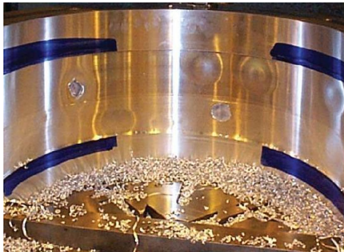
Figura 40. Formación de ampollas en cojinete guía.
