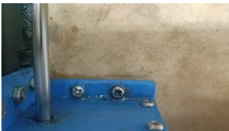
Figura 4.45: Fugas en medio de la carcasa.
