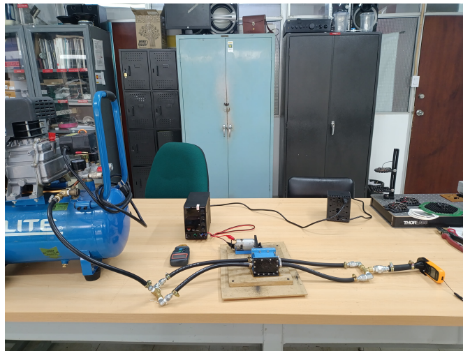
Figura 4.49: Montaje para prueba experimental del prototipo sellado con resina.
