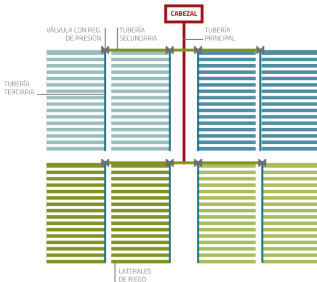
Figura 8.15. Componentes de un sistema de riego presurizado
