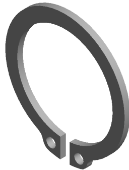
Figura F.1: Anillos de retención a ubicarse en el árbol de entrada del sistema propuesto por el algoritmo para el caso de estudio.
