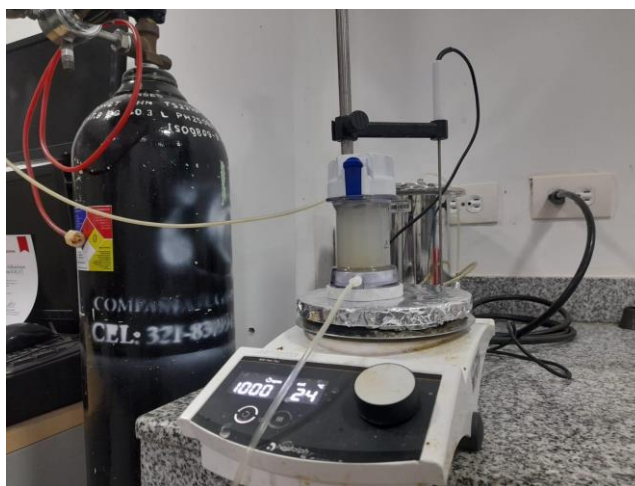
Figura 3. Montaje experimental en la celda de ultrafiltración.
