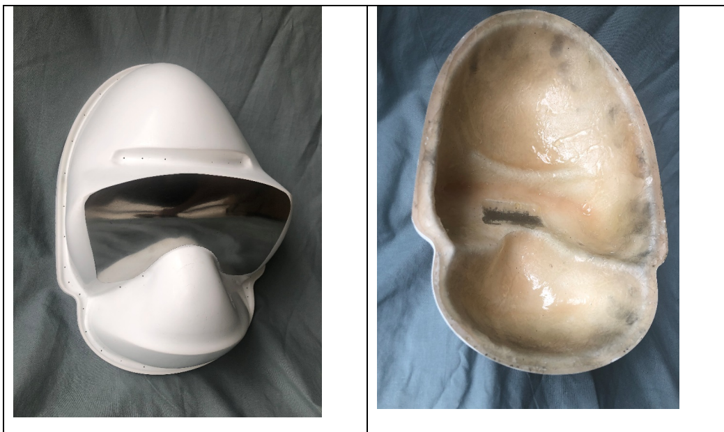
Figura 9. Elaboración de molde final para termoformado en fibra de Vidrio, resina poliéster y acero inoxidable.
