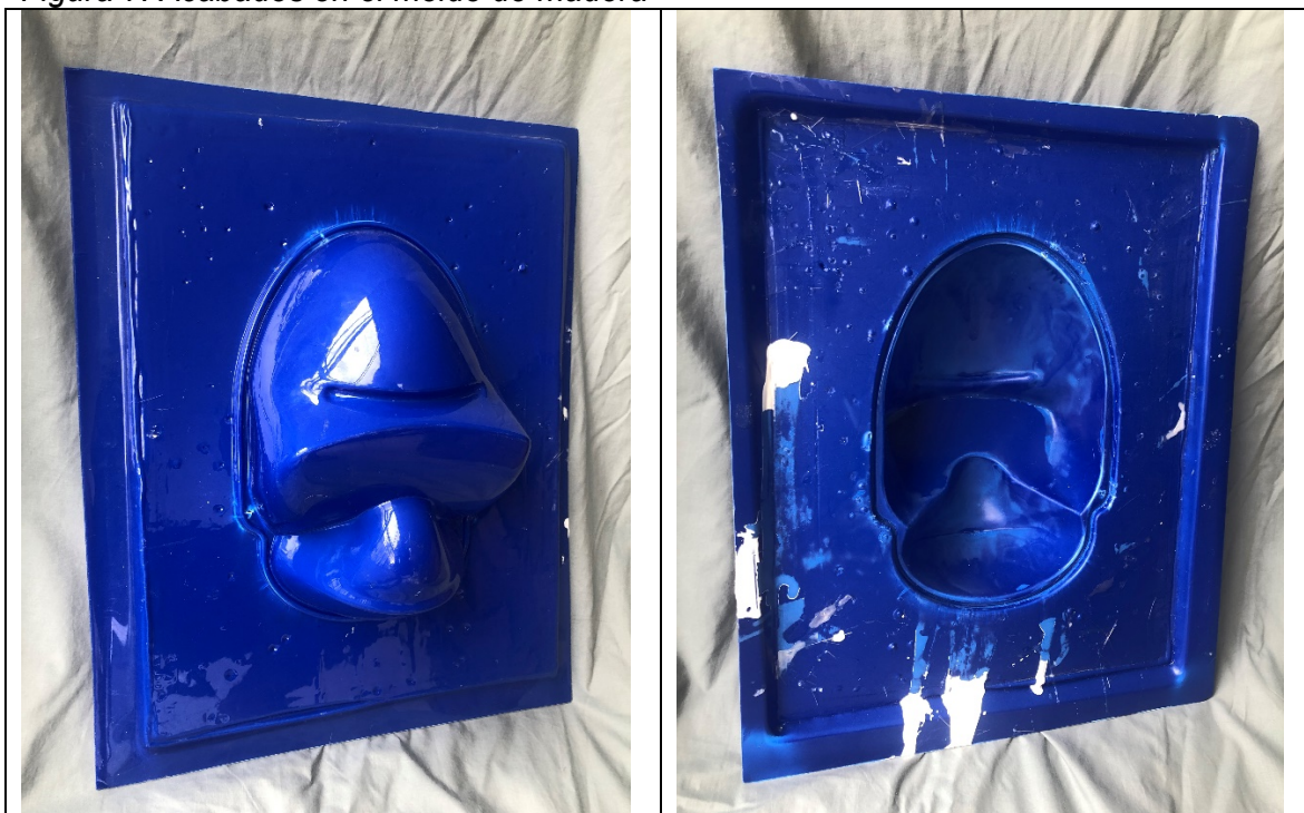
Figura 8. Termoformado en acrílico como molde.
