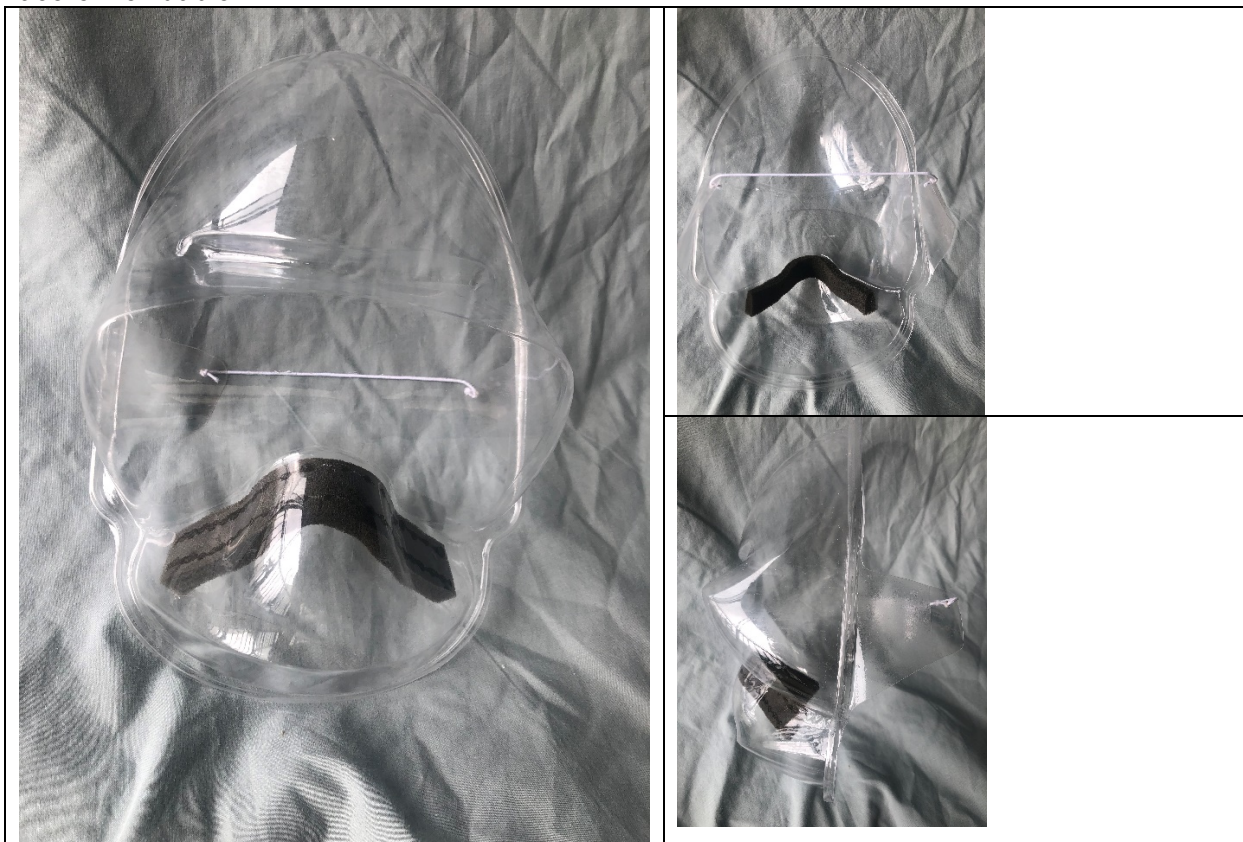
Figura 10. Prototipo en PETg termoformado
