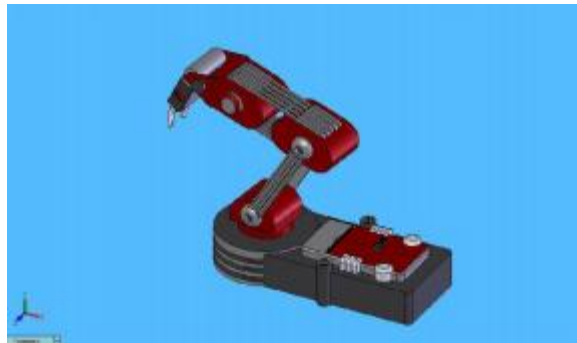
Figura 2. Modelo de un brazo robótico mediante Solidworks, Simscape, MATLAB
