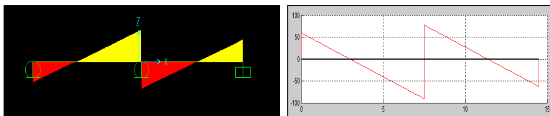
Figura 5. Diagramas de momento, Izquierda: Análisis SAP 2000, Derecha: Análisis CR-LAB.
