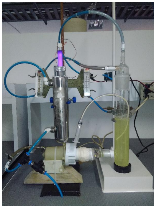
Figura 5. Montaje de fotoreactor para la degradación de la solución acuosa de K_3[Fe(CN)_6]
