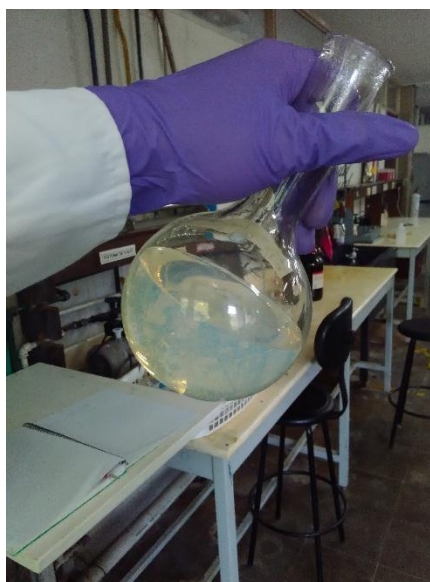
Figura 3. Catalizador sintetizado mediante el método sol-gel dopado con (a) Cerio (b) Lantano.
