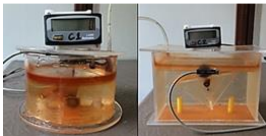
Figura 4.4 Contador volumétrico de biogás
