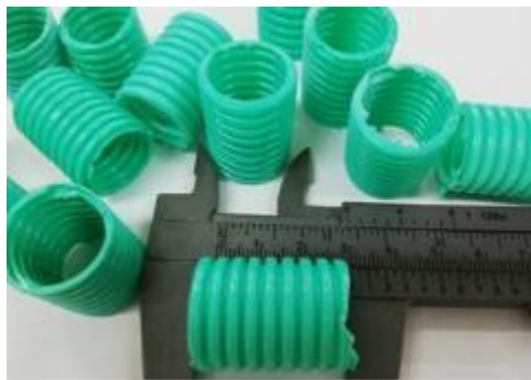
Figura 5.2 Medio de soporte: anillos en policloruro de vinilo corrugado
