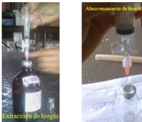
Figura 3.4 Toma de muestra de biogás
