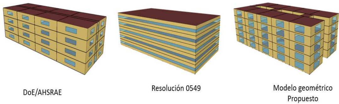
Ilustración 35. Comparación entre los diferentes modelos geométricos para la simulación energética. Fuente: elaboración propia.
