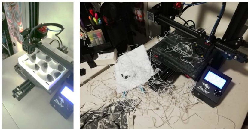
Ilustración 29. Fotografía a la izquierda, normal funcionamiento de la impresora fabricando el auto sombreado, a la derecha error en la fabricación por dejar la impresora funcionando sin supervisión al correrse el volumen que fabricaba. Fuente: elaboración propia.
