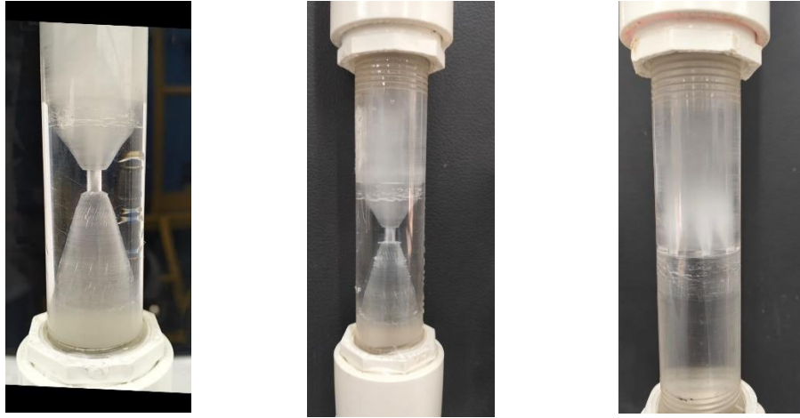
Ilustración 6. Fenómeno de cavitación observado en los elementos restrictivos del reactor: (a) Tubo Venturi en campo. (b) Tubo Venturi en laboratorio. (c) Placa perforada en laboratorio.
