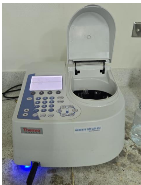
Ilustración 4. Espectrofotómetro Thermo Scientific GENESYS 10S UV-Vis utilizado para mediciones de absorbancia en el rango UV-Visible
