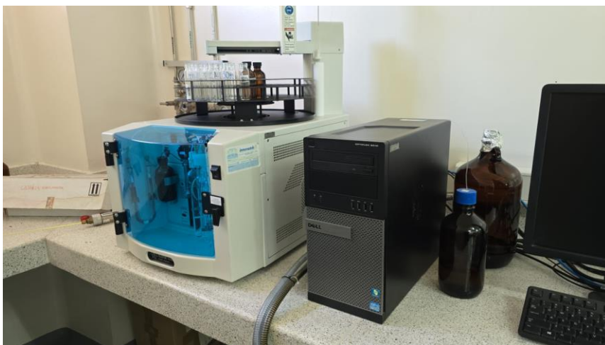
Ilustración 2. Teledyne Tekmar TOC-Torch. Nota: Creación propia.
