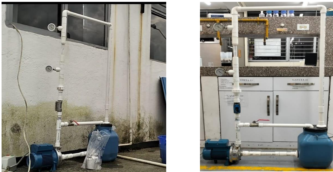
Ilustración 5. Sistema de tratamiento con cavitación hidrodinámica para tratamiento: a) in situ de agua PTAR. b) en el laboratorio.
