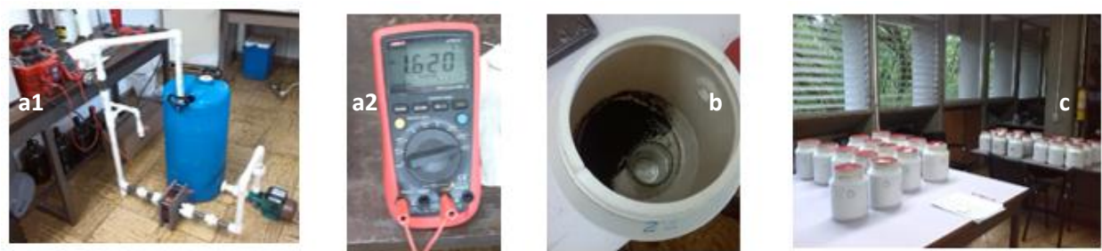
Fotografía 4. a1, a2. Se estimuló la solución de Multibiol® con agua a diferentes intensidades de campo electromagnético medidos con el multímetro Uni-t UT61C RS232 (USB) y a diferentes tiempos de exposición; b. 50 centímetros cúbicos de la solución de Multibiol se mezclaron con 50 g de gallinaza; c. Se realizó la prueba de actividad microbiana.
