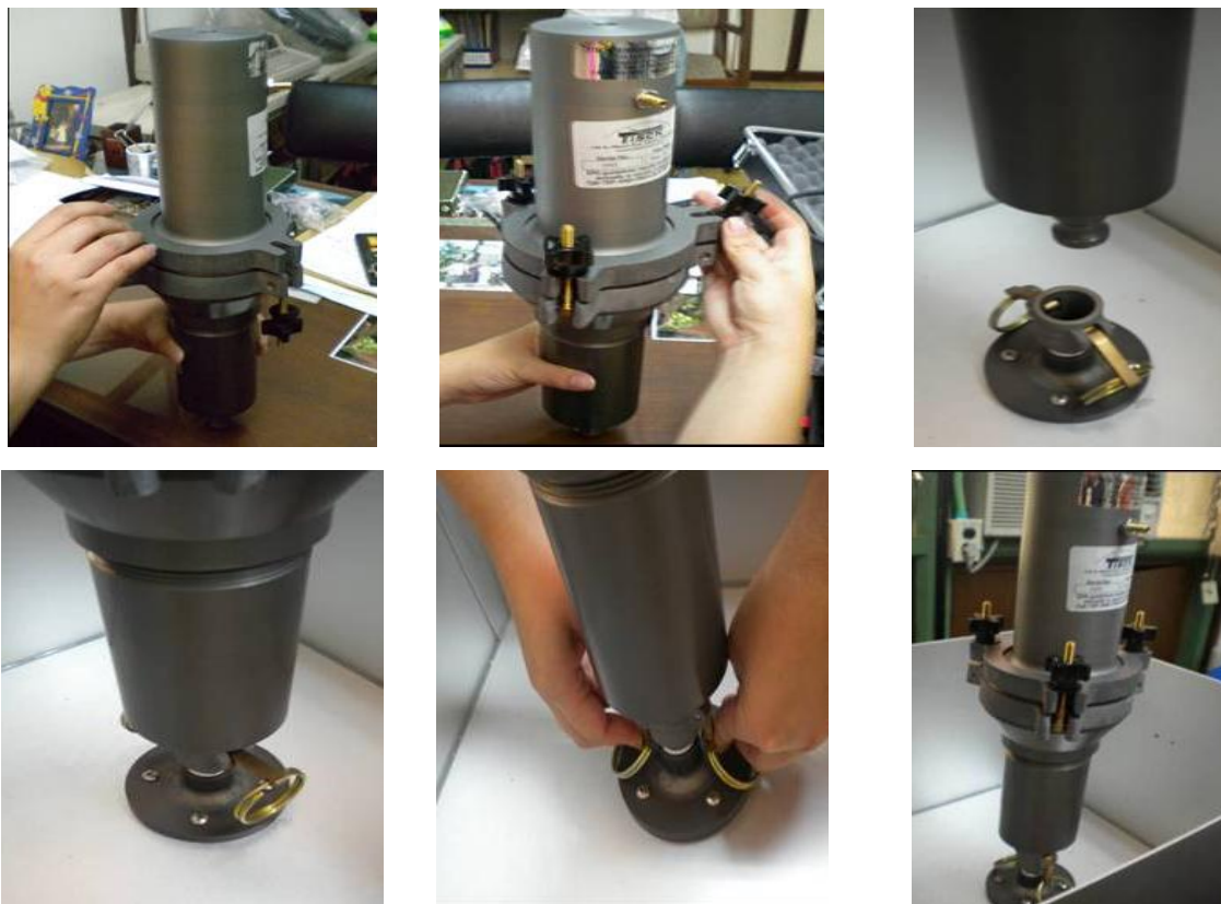
Figura 7.12 Ajuste del Calibrador al módulo PUF
