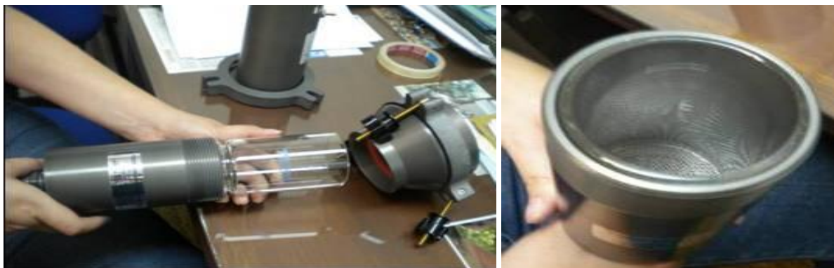
Figura 7.10 Ensamblaje del módulo PUF sin filtros para la calibración
