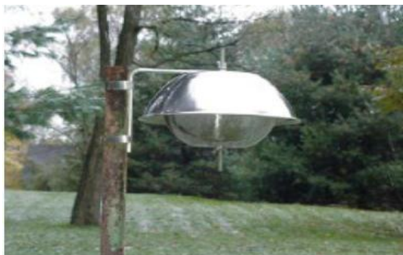
Figura 2.4 Muestreador pasivo diseño de platillo volador, con discos de espuma de poliuretano (PUF)
