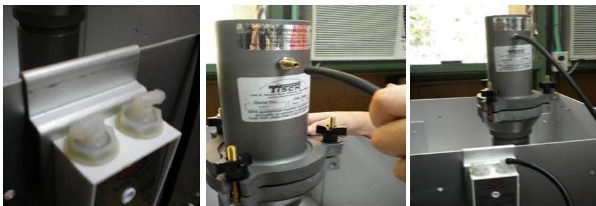
Figura 7.13 Manómetro con ambos puertos abiertos y Ajuste en el calibrador de la manguera que va al manómetro para la calibración
