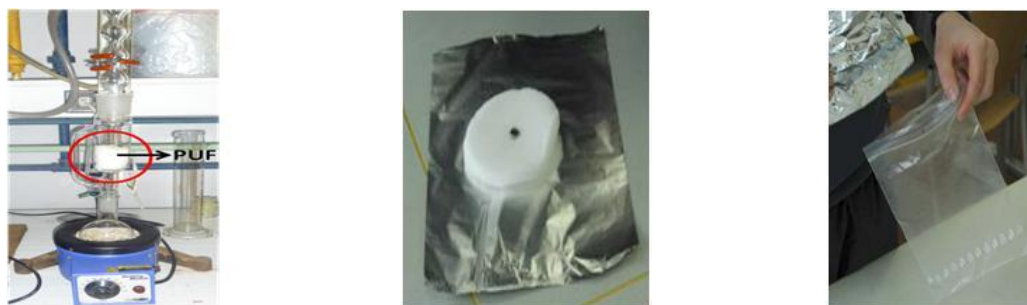
Figura 3.9 Fotografía del montaje experimental para limpieza de PUF.
