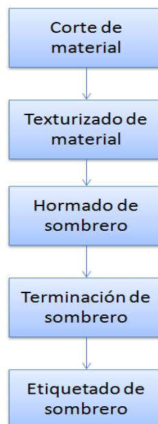
Figura 5. Diagrama de bloques del proceso productivo de los sombreros
