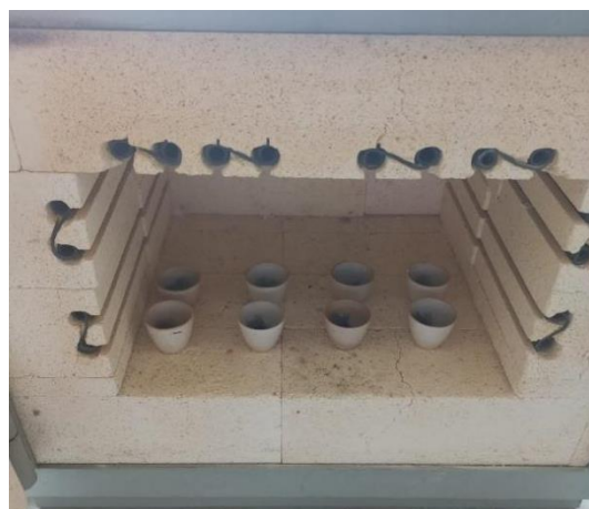
Figura 11. Análisis de cenizas en mufla
