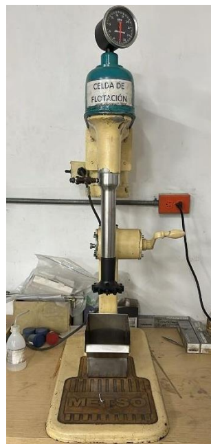
Figura 5. Celda de flotación
