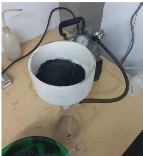
Figura 7. Filtración al vacío del flotado
