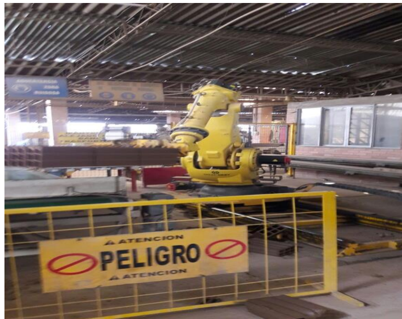
Imagen 18. Robot de recogida en banda transportadora, ladrillera Arcillas.
