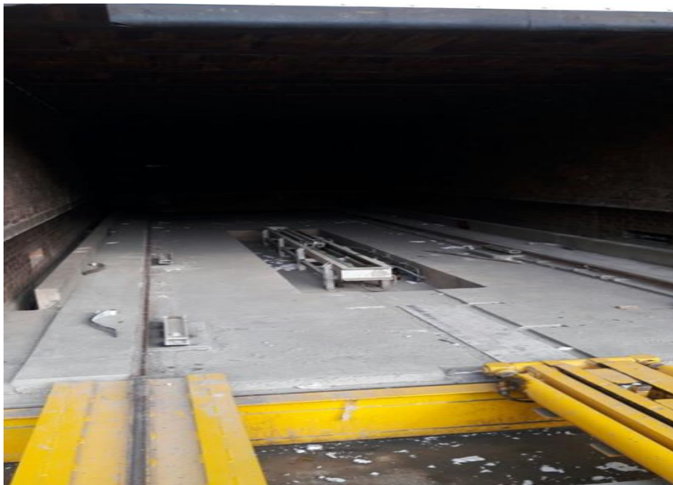
Imagen 23. Cámara de secado con aire caliente
