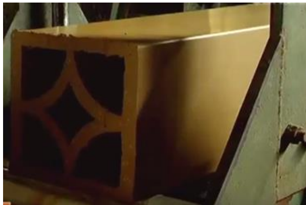
Imagen 15. Material salido de boquilla extrusora. Ladrillera Condina
