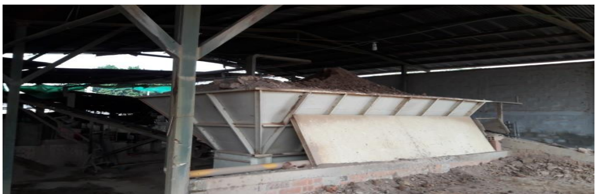
Imagen 87. Tolla de material, inicio de línea, ladrillera Condina
