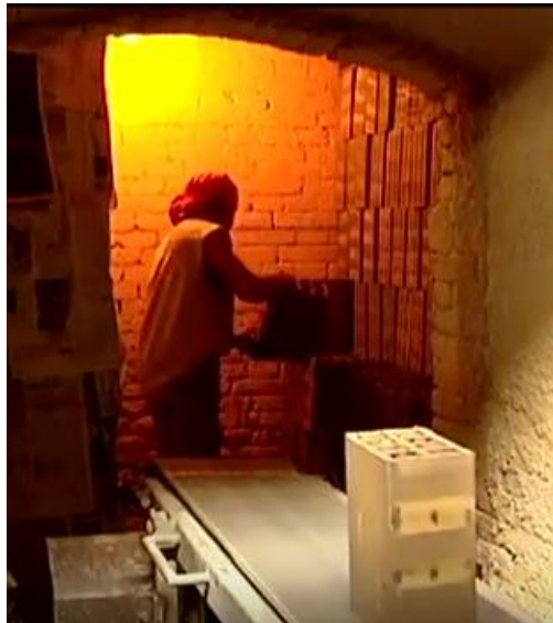
Imagen 17. Cargado del ladrillo seco al horno para posterior quemado de ladrillera Condina
