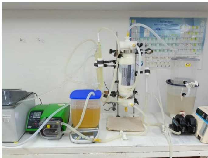
Figura 12. Sistema de evaporación osmótica a escala de laboratorio
