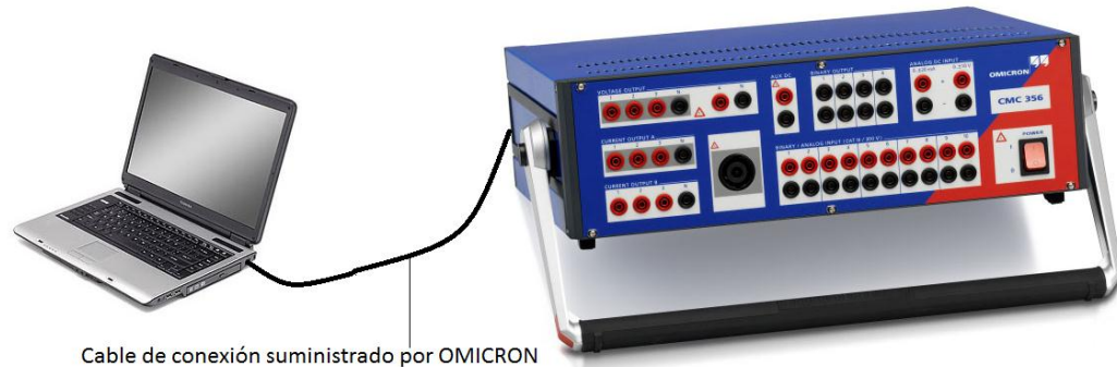
Figura 2.9. Conexión de la unidad CMC 356 al ordenador.
