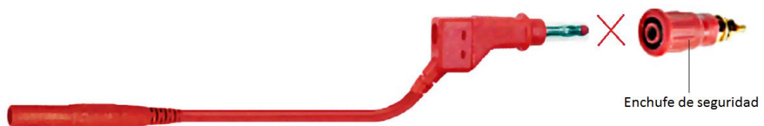
Figura 2.3. Mala utilización del cable en un enchufe de seguridad.
