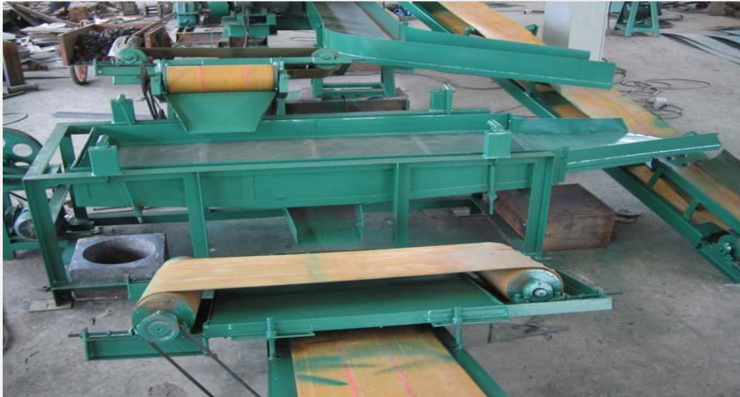
Gráfica 35. Ficha técnica de Máquina de aplastar en polvo
