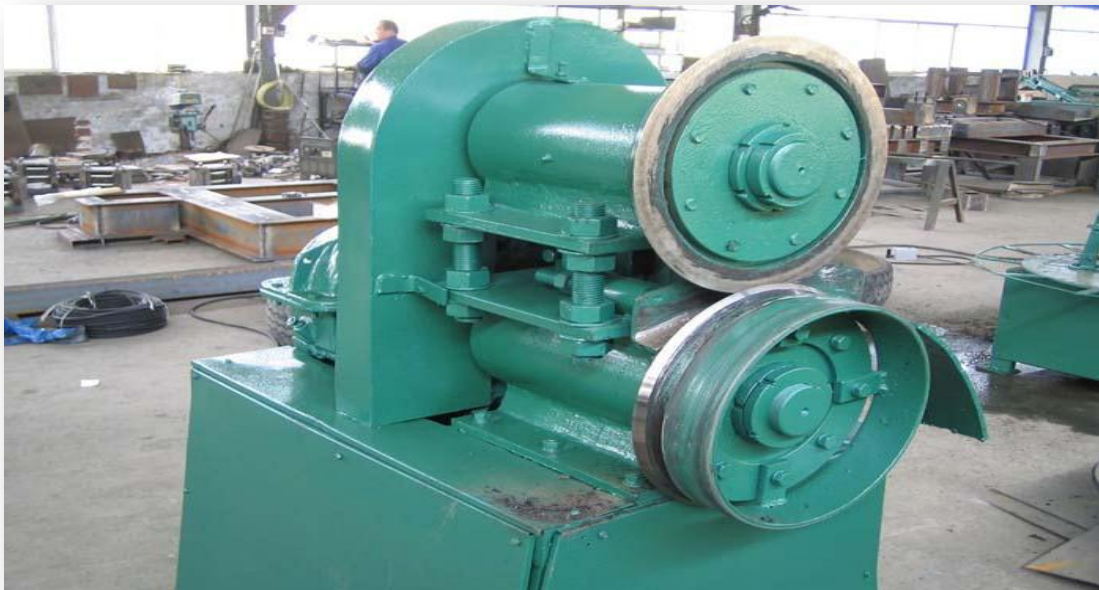
Gráfica 33. Ficha técnica de Cortadora lineal
