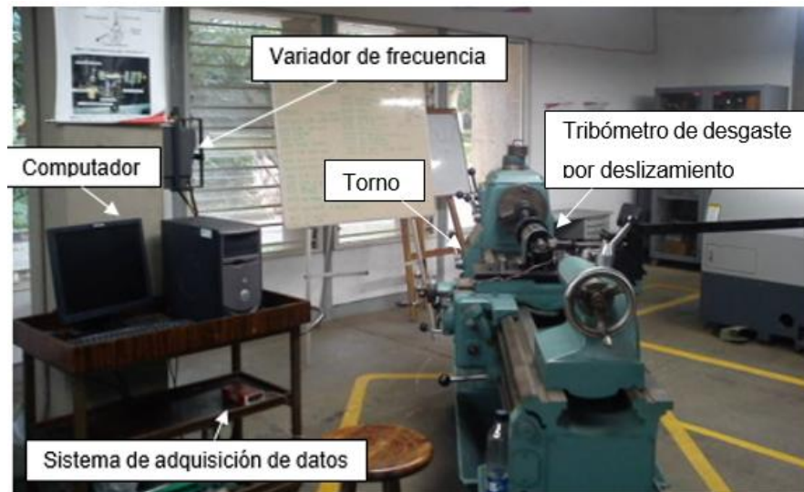
Figura 7. Componentes tribómetro de desgaste por deslizamiento.
