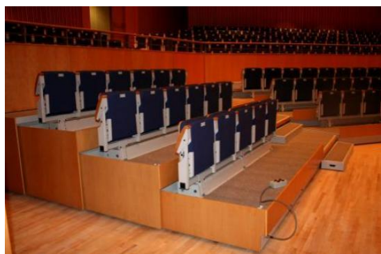
Arriba y abajo. Sistemas de retracción eléctricos. 2
