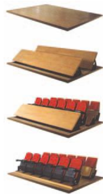
Diseño Conceptual de Sistema de gradas plegables en piso. 2
