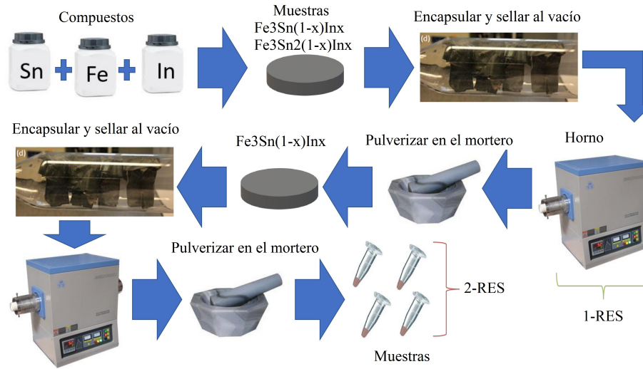
Figura 3.13: Esquema de la preparación de las muestras Fe_3Sn_{1-x}In_x y Fe_3Sn_{2(1-x)}In_x en forma de polvo con 1-RES y 2-RES.
