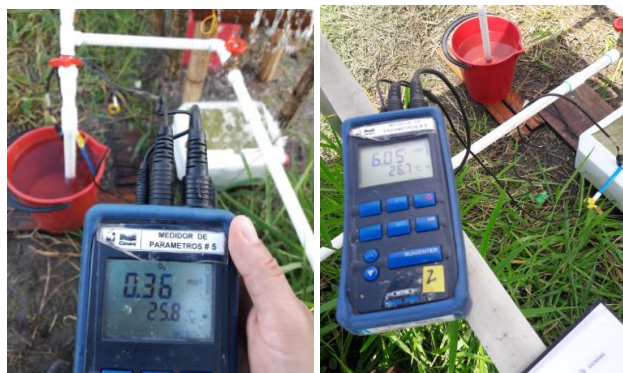
Figura 10. Toma de datos de OD, pH y Temperatura inicial con equipo de medición
