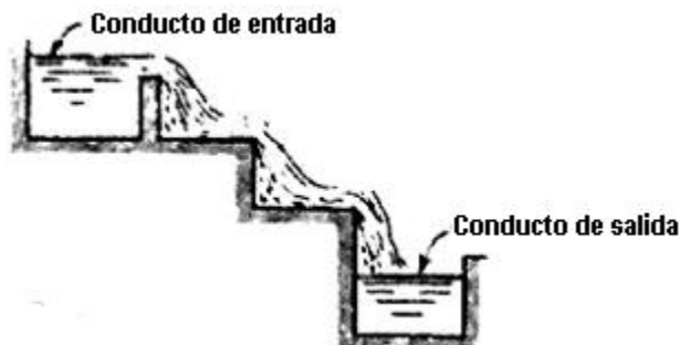
Figura 3. Aireador en cascada o escalonado. Fuente: (Pöpel, 1995)
