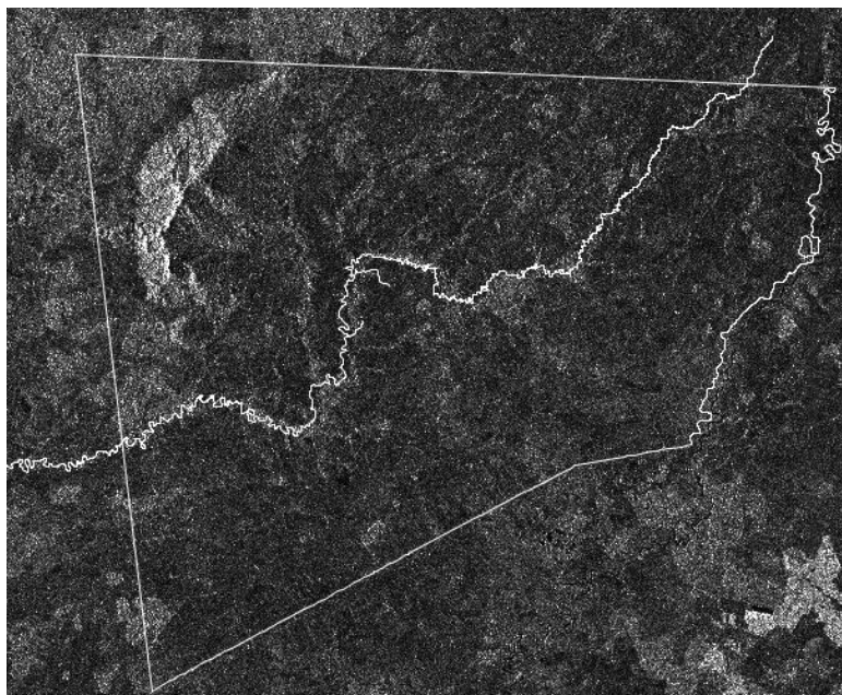
Figura 5. Reducción de ruido térmico de imágenes SAR
