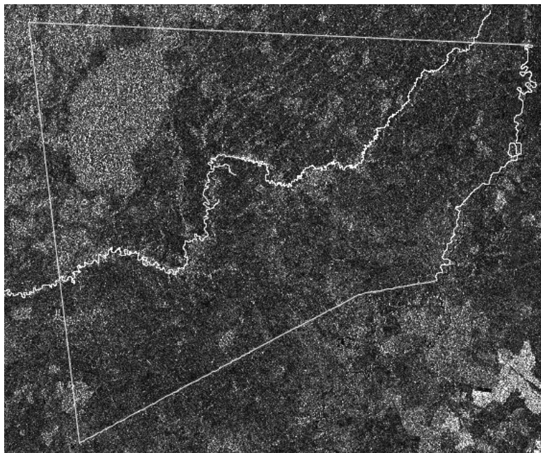
Figura 7. Imagen de calibración radiométrica de terreno (Terrain Flattening)
